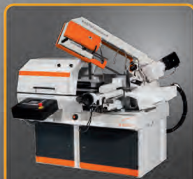
Scie à ruban entièrement automatique KASTOfunctional A
