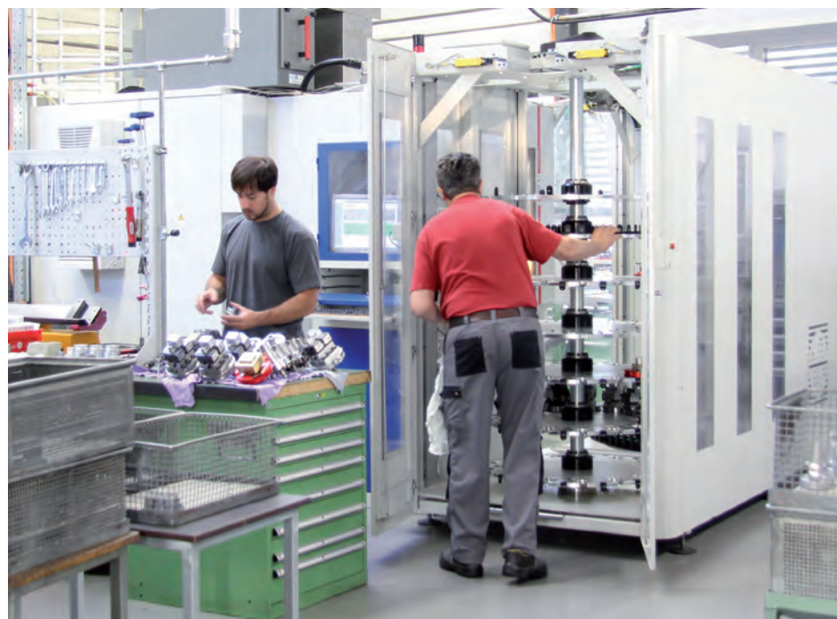
» Gage de sécurité, la préparation hors machine s'effectue sans stress, pendant l'usinage MTS 2.0 communique avec la machine pour confirmer la réalité du bridage pièce sur la machine
