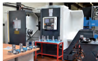
➤ Tour ACE Multi-Fonction Vantage 800YM, avec tourelle motorisée et axe Y, installé chez un client aéronautique ; l'un des produits phare de la marque ACE.
