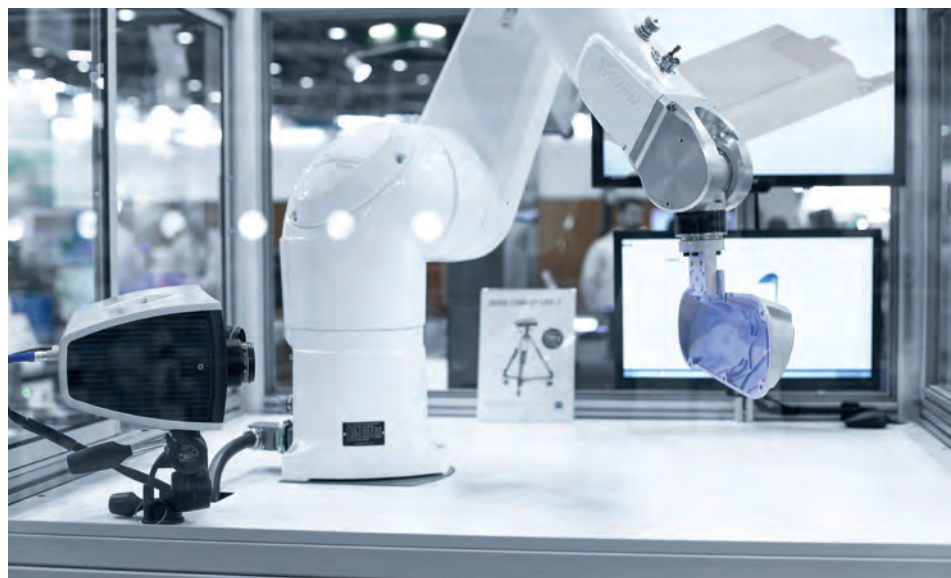
► Le bras du robot vient automatiquement prendre les pièces et les dépose dans la MMT pour le contrôle
