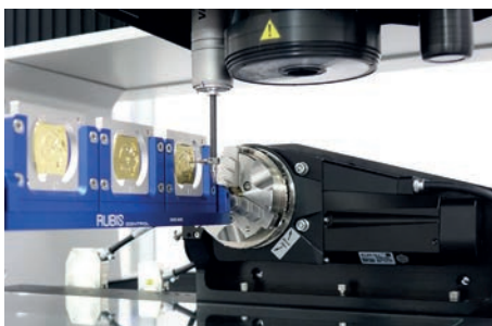
➤ Posage de carrure de montre
