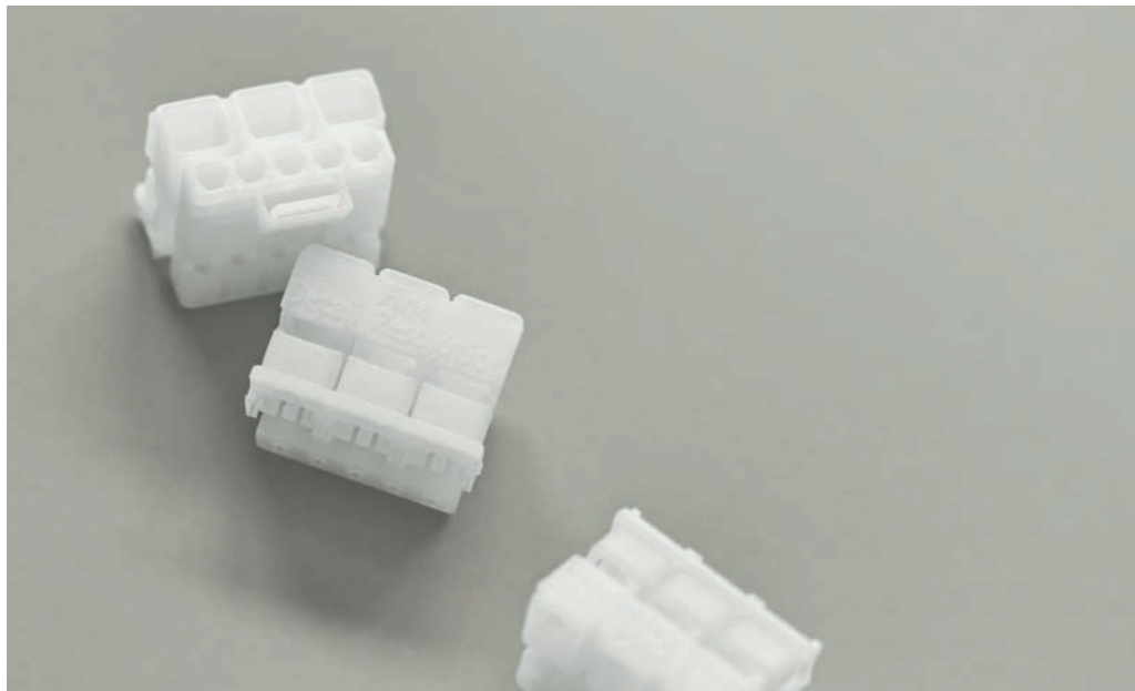
» La technologie polymères Fine Detail Resolution (FDR) permet la production de surfaces ultra fines et de composants très délicats (Source: EOS)
