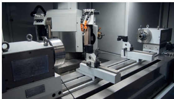
» La KEL-1000/1600 entre-pointe intègre une poupée porte-pièce à entraînement direct & la contre-pointe synchronisée
