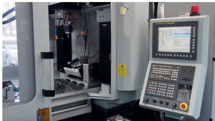
► Hauser H-55 équipée du plateau diviseur à inclinaison rotative, offrant à la machine pas moins de 8 axes
