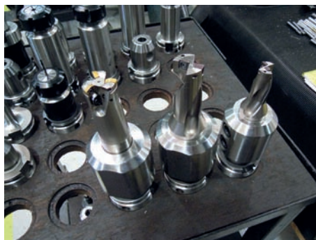
» Trois des fraises Mitsubishi (fraise AJAX et forets MVX) devant la machine ayant servi à réaliser une pièce plus complexe que d'habitude
