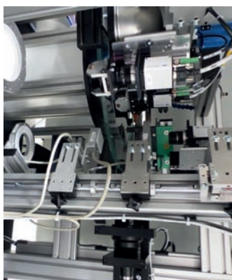
» Système de contrôle Visiort-T doté de huit caméras
