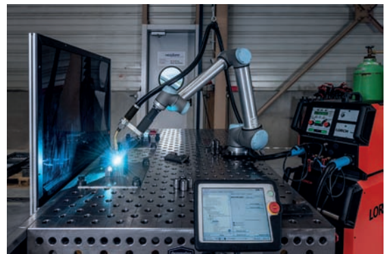
► Compact et flexible, sans barrière de protection, le Cobot de soudage de Lorch peut être intégré rapidement dans n'importe quel environnement de production
