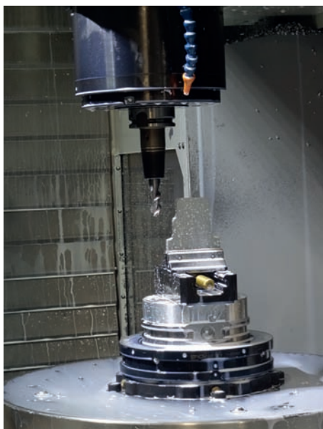
» Le B-Cool 755 est un lubrifiant soluble polyvalent, adapté au contexte d'arrosage haute pression au centre de l'outil
