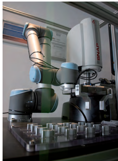
» Un SNAP est desservi un robot qui effectue la mise en place, le retrait et le tri des pièces à mesurer
