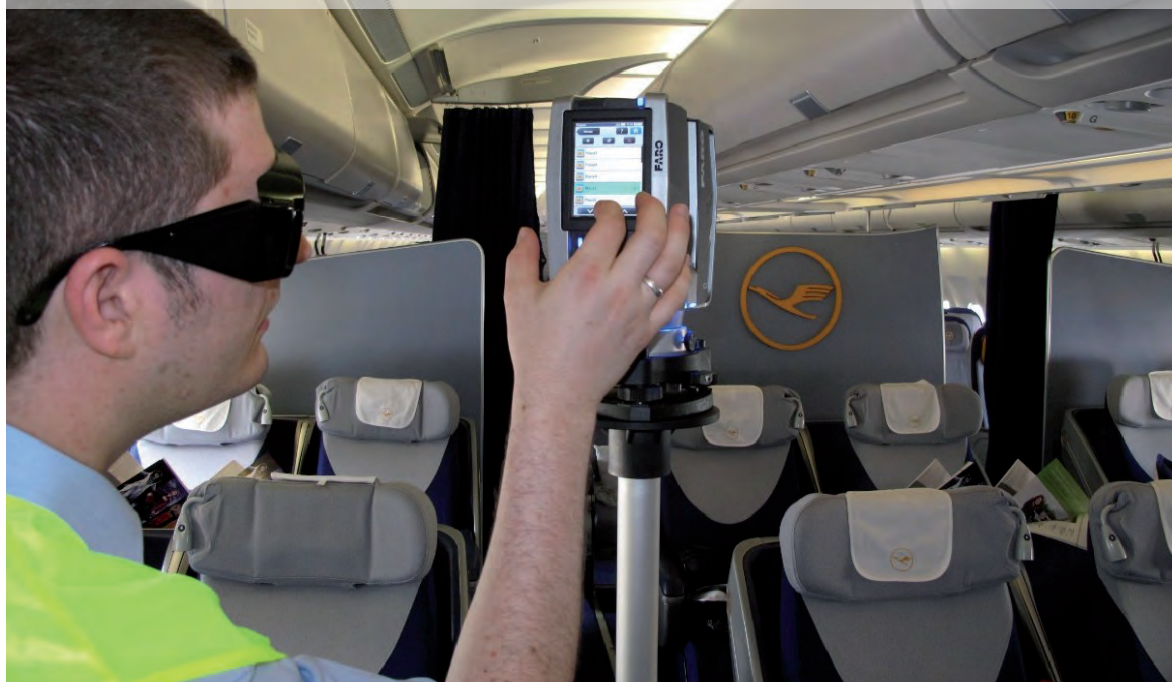
» Le scanner laser Focus3D de Faro pendant l'opération de numérisation dans la cabine d'un Boeing de la Lufthansa
