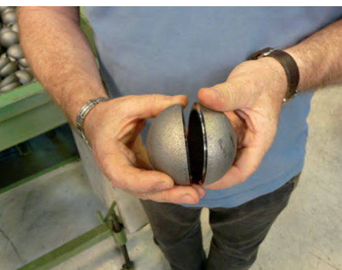
► Les coquilles obtenues par forgeage seront ensuite usinées et soudées
