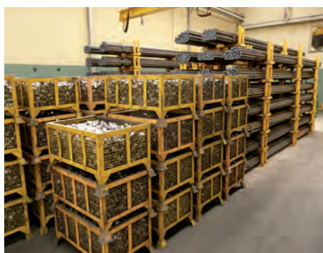
» Au début du processus, des barres d'acier et d'inox sont coupées en lopins.
