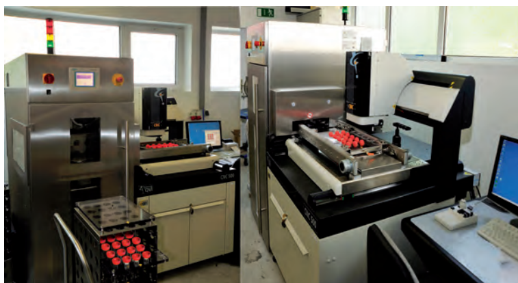
» Cellule robotisée autour d'un SmartScope CNC500 destinée à la production de flaconnerie médicale.
