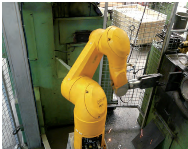
► Après le soudage, le robot TX90 de Staubli prend la pièce, contrôle sa géométrie puis la dépose dans la strieuse avant d'être polie
