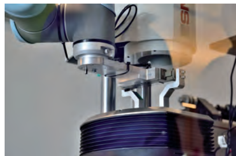
» La mise en place des pièces se fait sans risque : comme aucun élément n'est mobile, les posages sont inutiles.
