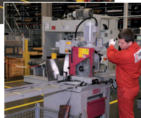
» La fraise-scie Eisele type VM5 pour la coupe unitaire à la moyenne série
