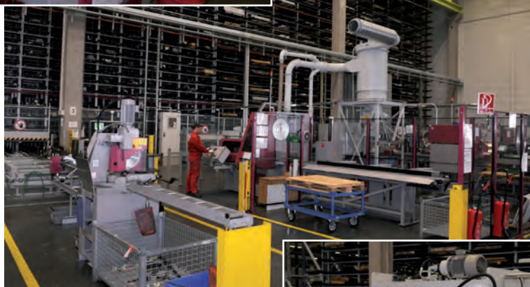
» La fraise-scie Eisele type VM5 pour la coupe unitaire à la moyenne série
