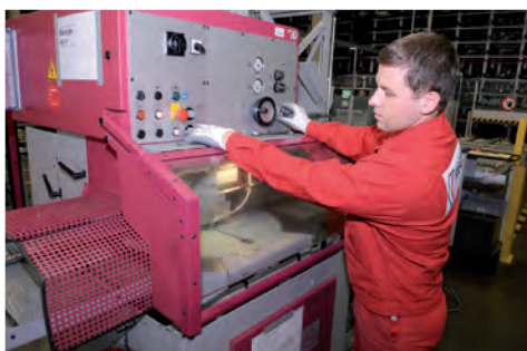
» Un employé de Fiege actionne la rotation de la table circulaire de la PSU 450 A automatique de Behringer Eisele permettant d'effectuer des coupes biaisées
