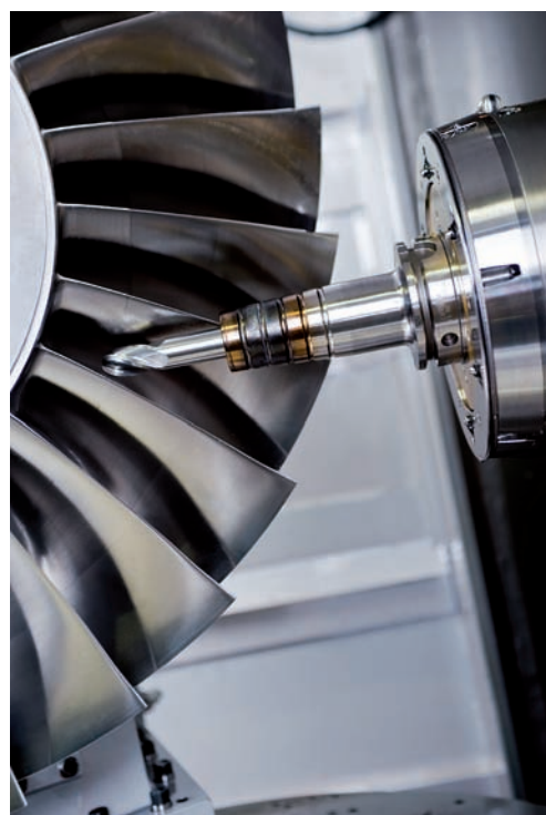
» Usinage de Disques Aubagés Monoblocs pour les moteurs d'avion
