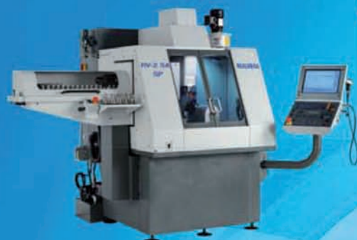
Centre UGV de super précision REALMECA RV2-SA Fraisage de pièces complexes de micromécanique
