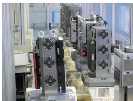
» Avec une puissance de serrage MTS 2.0 assure une totale sécurité pour le positionnement de cubes de bridage et des montages multi-pièces
