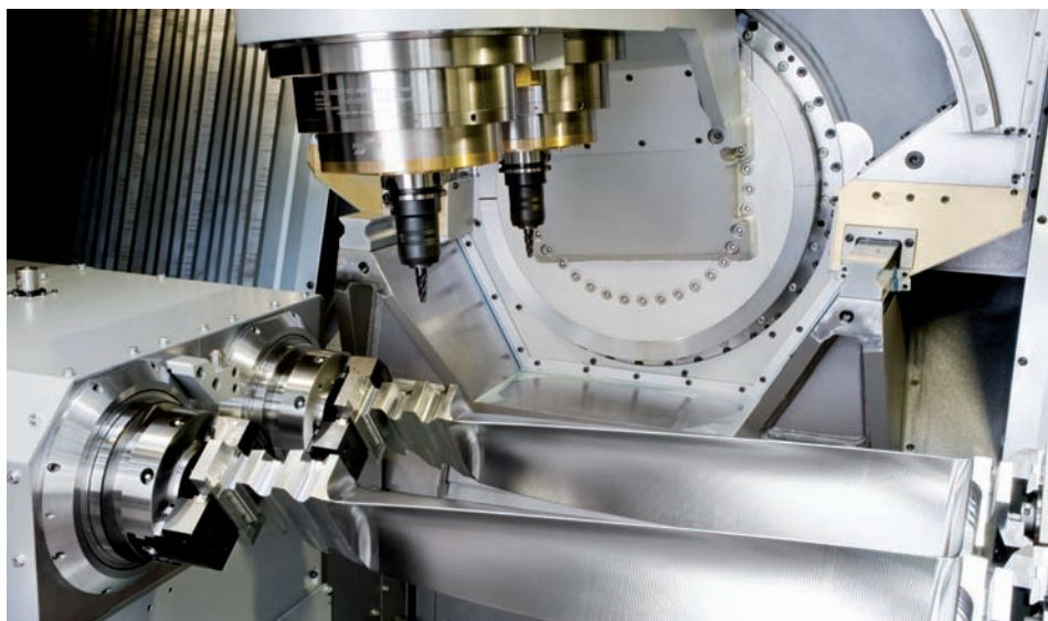
Usinage d'aubes pour les moteurs d'avion et turbines de production d'énergie
