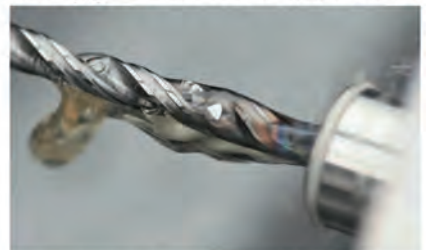
Les copeaux fragmentés s'évacuent le long des goujures de foret.
