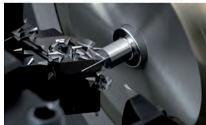
Micro-usinage d'une aiguille de diamètre 0.2mm
