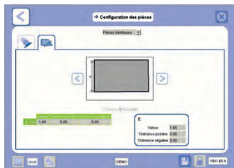
» Un résultat garanti et reproductible. Exemple de paramètres mécaniques pour la préparation des extrémités des tubes, tels qu'ils apparaissent sur le système P4 de Polysoude
