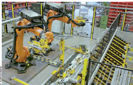
» L'alliance d'un robot et d'un système de cintrage permet de traiter des conduites pouvant atteindre 4 500 mm de longueur
