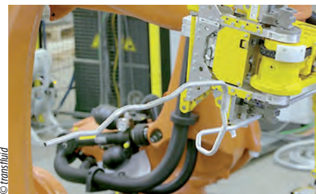
» Chaque robot possède 7 axes moteurs et peut cintrer à droite comme à gauche
