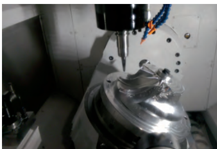
» De nombreuses démonstrations intéressantes d'usinage de composants aéronautiques en direct, tels que des rotors en aluminium.
