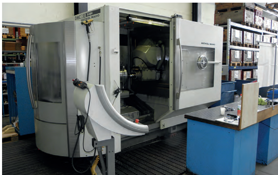
► Chez Ray AG, la fabrication et la mesure s'effectuent notamment sur des centres d'usinage 5 axes DMC 80U hi-dyn, équipés de palpeurs de mesure de m&h
