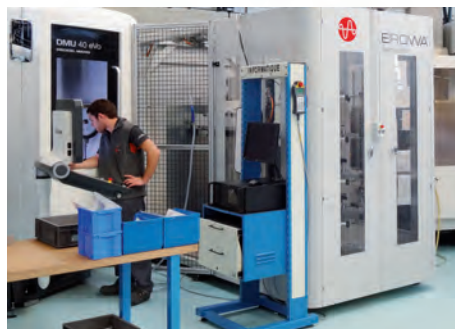
» RobotMulti : desserte de 2 machines - 270 emplacements pièces
