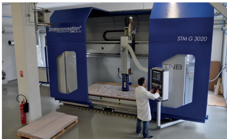
➤ Station de stratoconception Résine et Alu Grandes dimensions STM G 3020, en cours de fabrication de la plaque modèle
