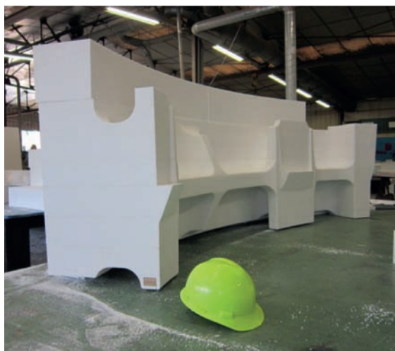
► Outillage de fonderie sable en Strato PSE réalisé en interne par Ferry Capitain
