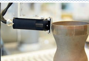
Suivi et contrôle non destructif des réalisations en fabrication additive. © CEA
