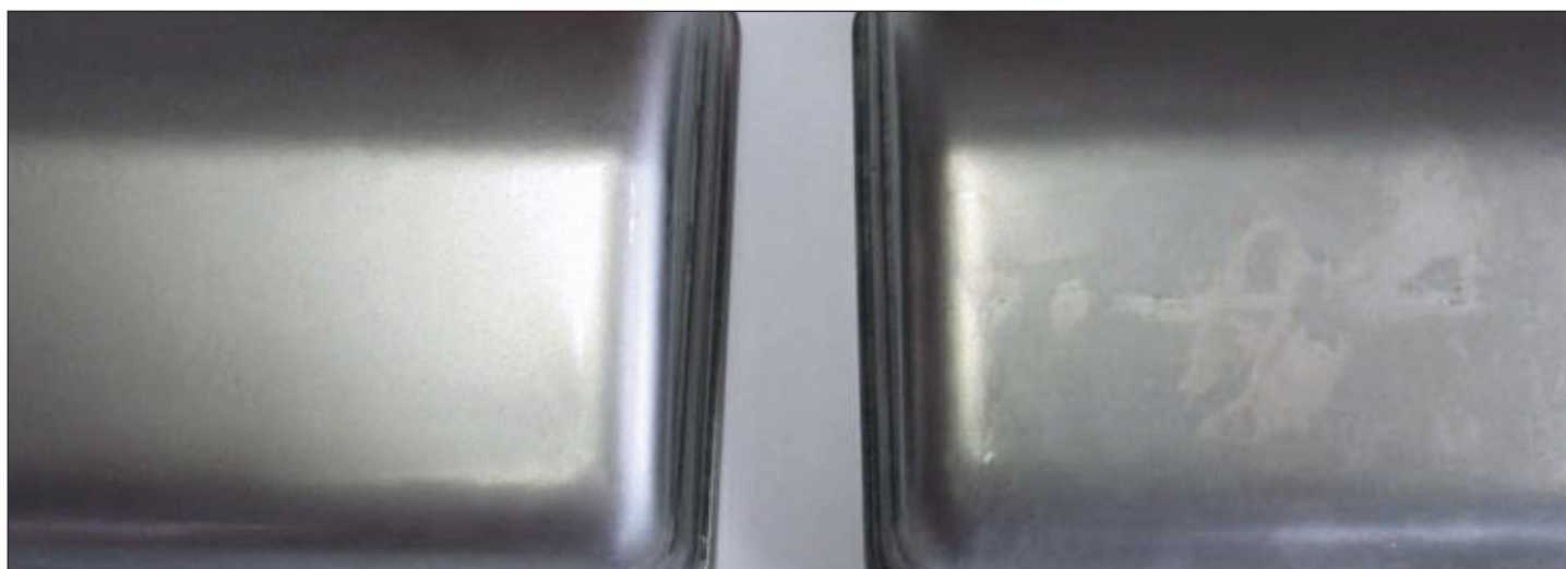
► Pièces lavées dans la TwinTec : comparée au lavage au solvant seul, la combinaison avec des produits lessiviels augmente la qualité
