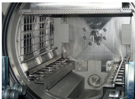
Intérieur d'une chambre de lavage sous vide et nettoyage ultrasons
