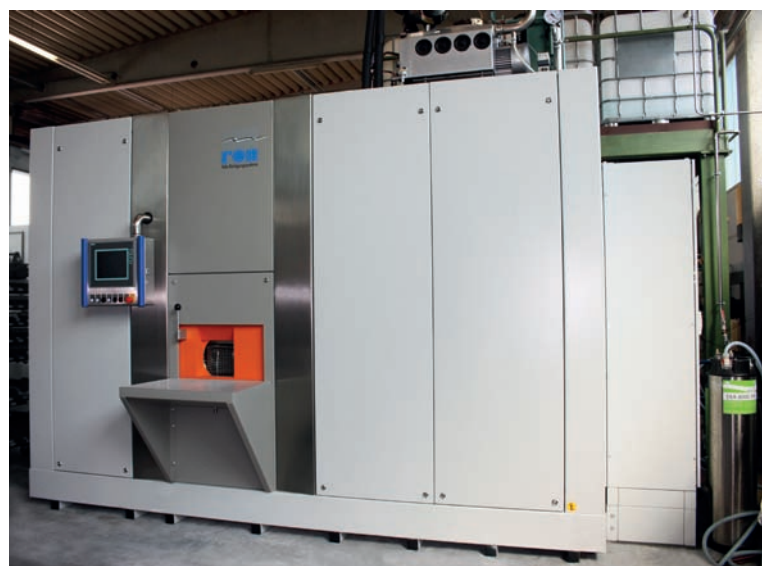
➤ La nouvelle machine TwinTec est appropriée pour le lavage combiné avec solvants et lessives, des produits employés dans la même cabine de lavage
