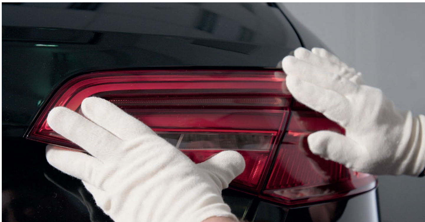
► Le centre d'impression 3D plastique Audi va utiliser l'unique imprimante 3D J750 pour produire des cabochons en une seule impression
