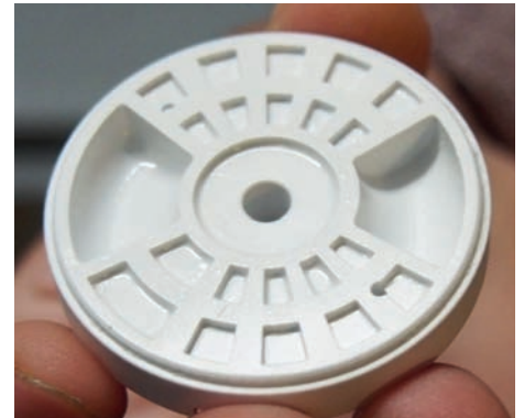
► L'impression 3D céramique présente de nombreux avantages en matière de rigidité et de formes complexes de pièces
