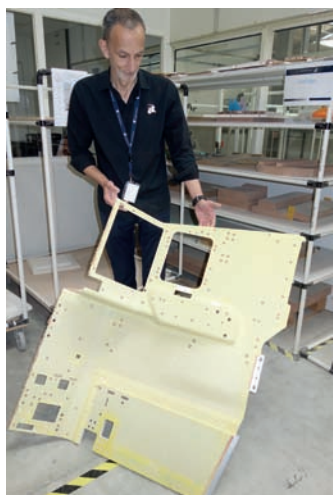
» Élément de siège first class. Détournage en 5 axes et perçage en positionné (client Zodiac France)
