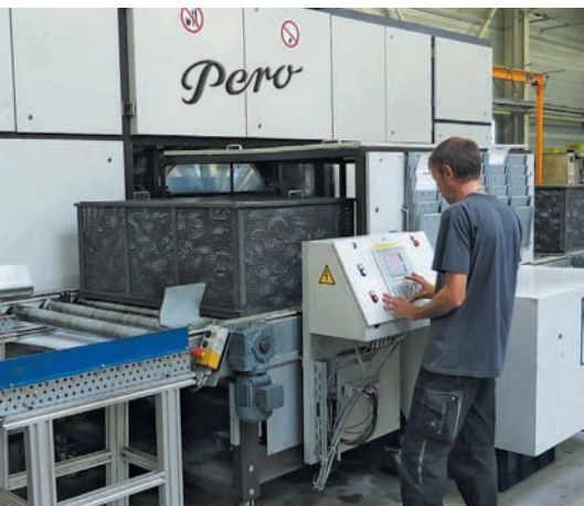
» La machine Pero V4 reçoit des paniers de 1200 x 800 x 450mm pour le nettoyage solvant sous vide
