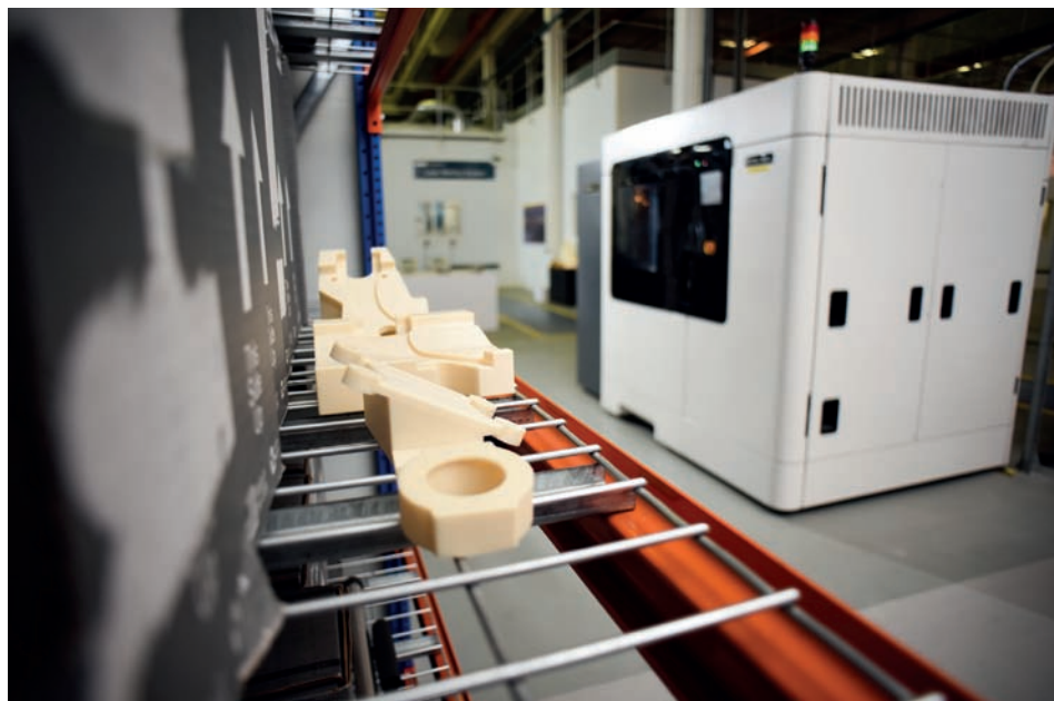
» Outillage imprimé en 3D, produit sur l'imprimante 3D de production F900 de Stratasys
