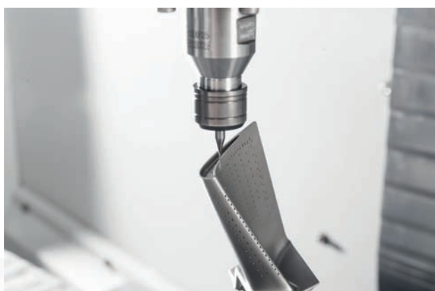
TTGroup VU-5 – Perçage de petits trous
