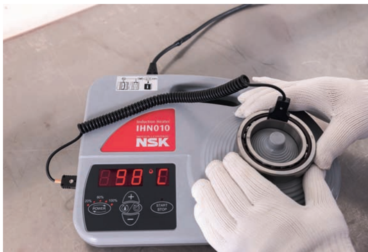
► L'installation à l'aide du bon outil (ici, un chauffe-roulements à induction) contribue grandement au bon fonctionnement des roulements sur une longue période
