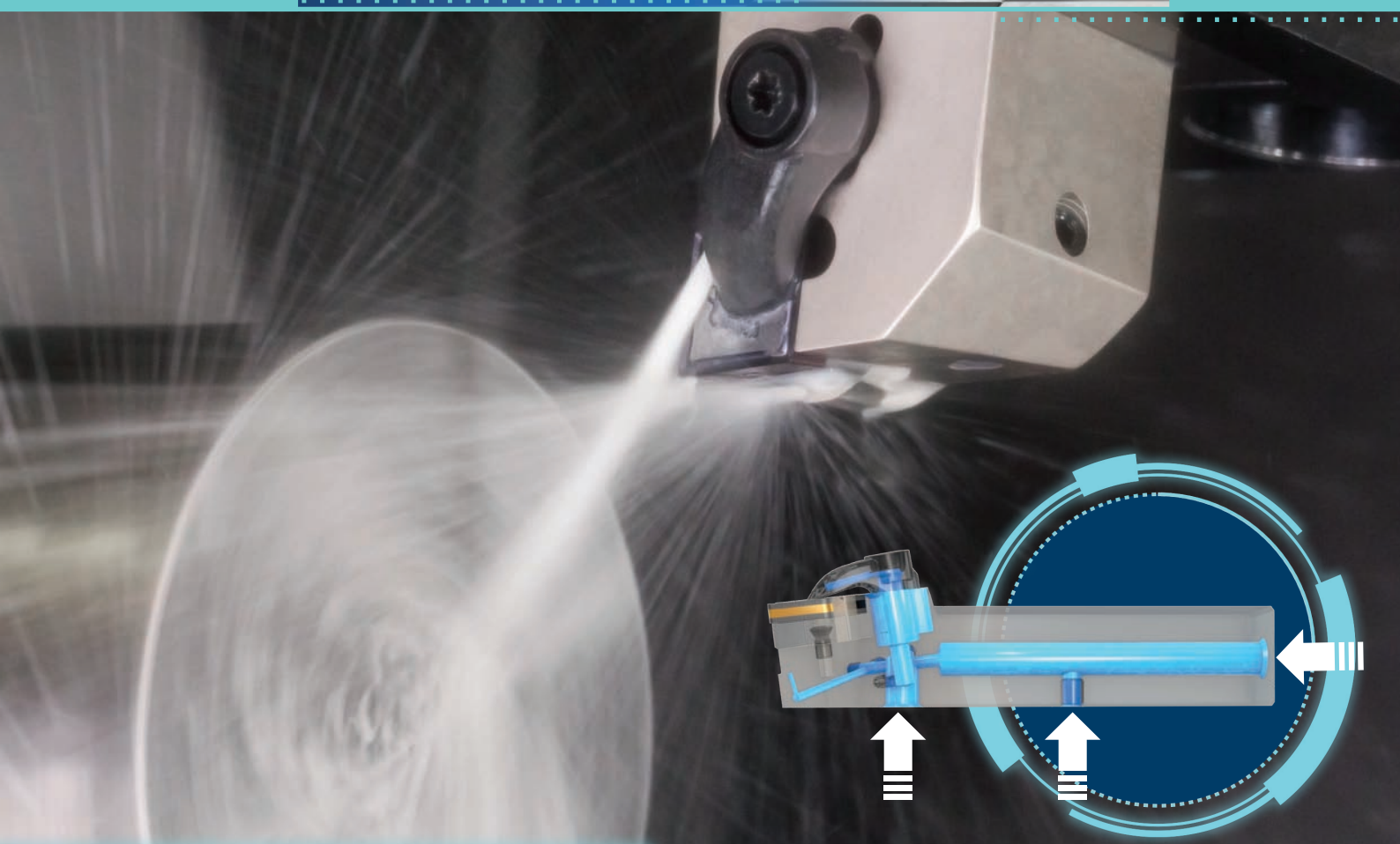
Nouveau porte-outil avec 3 entrées de lubrifiant
