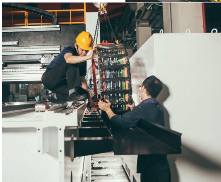
► Les installations d'usinage à portique de la société Hartford disposent d'une alimentation en énergie sûre et fiable grâce aux chaînes porte-câbles Igus. (Source : igus)
