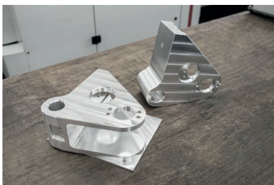
► Un petit échantillon de l'éventail de pièces exigeantes fabriquées à partir des matériaux St 52, CroNiMo 34, inox ou aluminium ; ici, des pièces de châssis complexes en St 52
