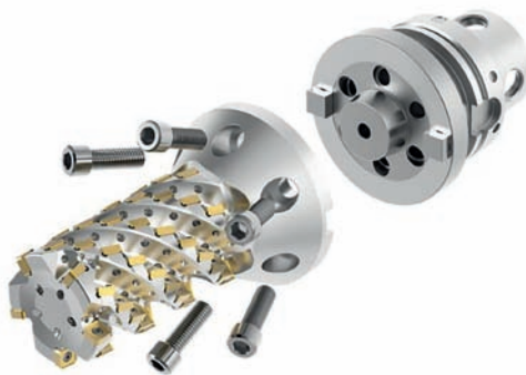
» La géométrie à hélice variable de la HU8X brise les fréquences responsables des vibrations d'usinage
