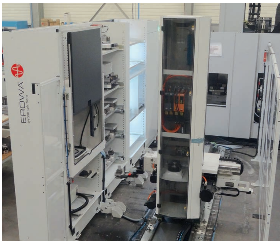
» Magasins, station de soufflage des pièces et robot ERD150L
