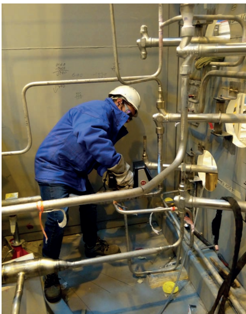
► Le Z-200C+ permet de vérifier les alliages des éléments de « piping » (tubes, brides, coudes...) et de contrôler les soudures
