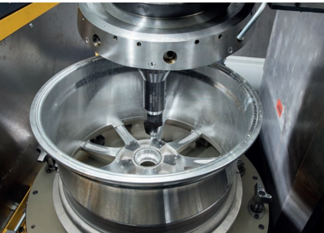
► Tournage des rayons au cours d'une coupe interrompue
