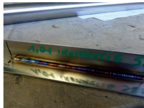
► Comparatif entre l'Argon et l'Inomaxtig en protection à l'endroit et à l'envers sur un tube et vue sur la qualité de la pénétration*
