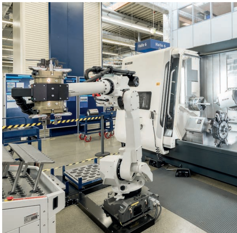
➤ Chargement et déchargement automatisé de tour à commande numérique.
