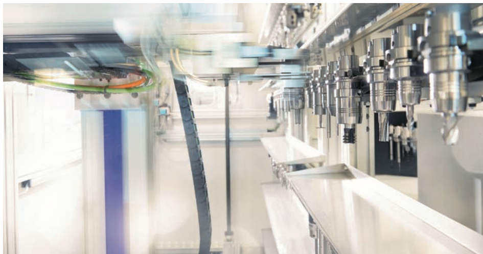
➤ Pour plus de flexibilité dans l'usinage le magasin de porte-outils SCHUNK dans l'usine de production d'Hausen comporte plus de 240 modèles.
