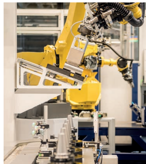
➤ Mesure et contrôle automatisé des porte-outils (géométrie, concentricité, serrage).
