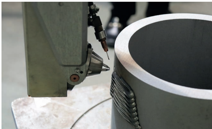
► L'objectif de ces journées était, notamment, de montrer l'apport de productivité du rechargement par soudage TIG...
