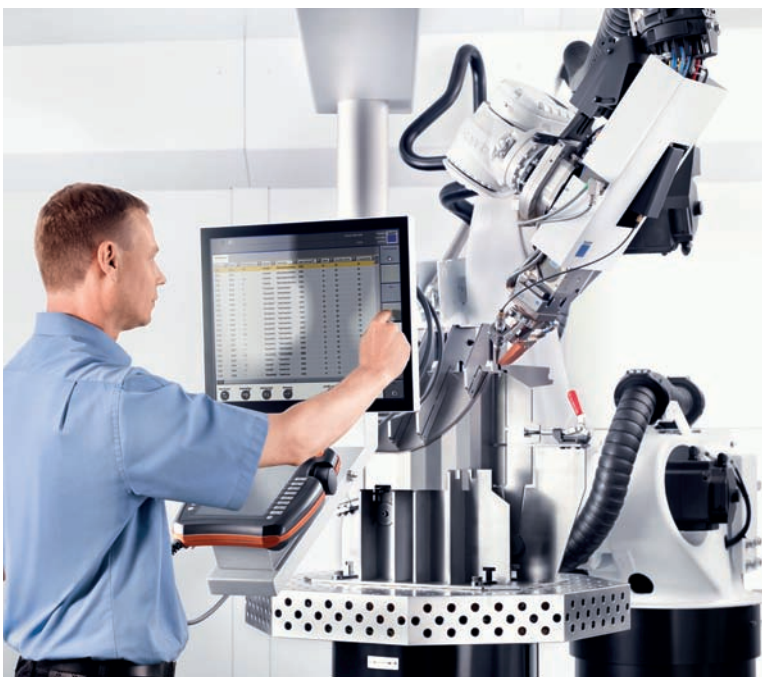
➤ Au lieu d'apprendre au robot chaque point de déplacement individuel, TruTops Weld calcule automatiquement les mouvements du robot
