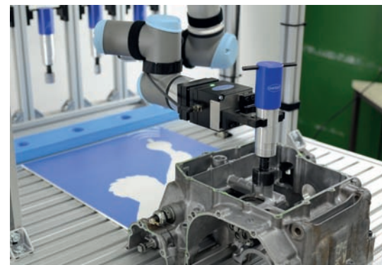
► Diatest a acquis dans l'automobile une expérience lui permettant de répondre à de nombreux cas de mesures et de contrôles entièrement automatisés
