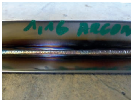
► Comparatif entre l'Argon et l'Inomaxtig en protection à l'endroit et à l'envers sur un tube et vue sur la qualité de la pénétration*
