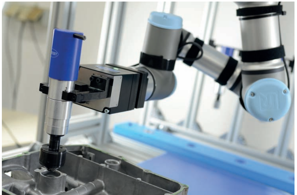
► Il est possible aujourd'hui de contrôler les pièces en production sans intervention humaine ou d'effectuer une mesure avec un robot à l'intérieur de la machine
