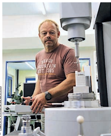
» Précision maximale: Werner Buschor et son équipe inspectent les composants sur une machine à mesurer de haute précision.
