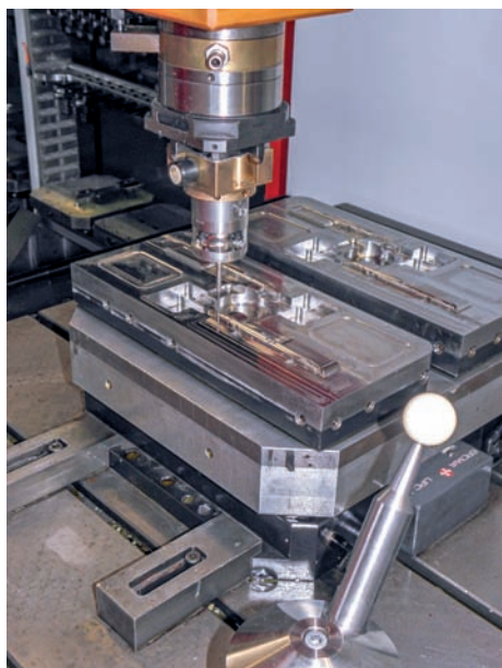
» La mesure des pièces à l'aide du logiciel 3D Form Inspect garantit la fiabilité de production, même dans les machines d'électro-érosion
