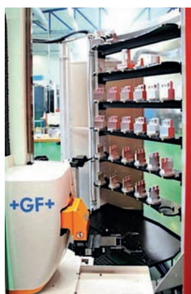
» Le magasin de pièces et le robot de changement 3R sont placés entre les deux centres de fraisage Kern
