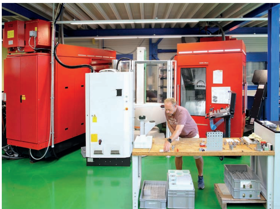
» Werner Buschor a placé les deux centres de fraisage Kern Micro de manière à ce que les deux centres puissent être actionnés au centre par un changeur de pièces.
