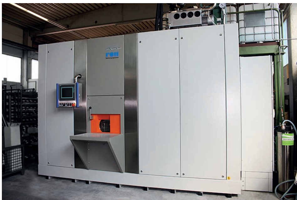
» La nouvelle machine TwinTec est appropriée pour le lavage combiné avec solvants et lessives, des produits employés dans la même cabine de lavage
