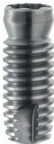
► Implant dentaire. Usiné sur M16-V, diamètre 4,1 x 10,75 mm, titane grade 5, 155 secondes
