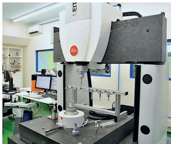
» Précision maximale: Werner Buschor et son équipe inspectent les composants sur une machine à mesurer de haute précision.
