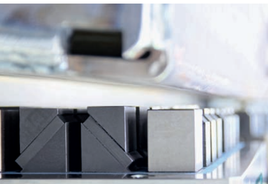
» Les rallonges de pôles mobiles Easyturn (présentées en noir ici) peuvent être ajustées en toute facilité à la pièce à usiner, et elles garantissent un montage à faible déformation
