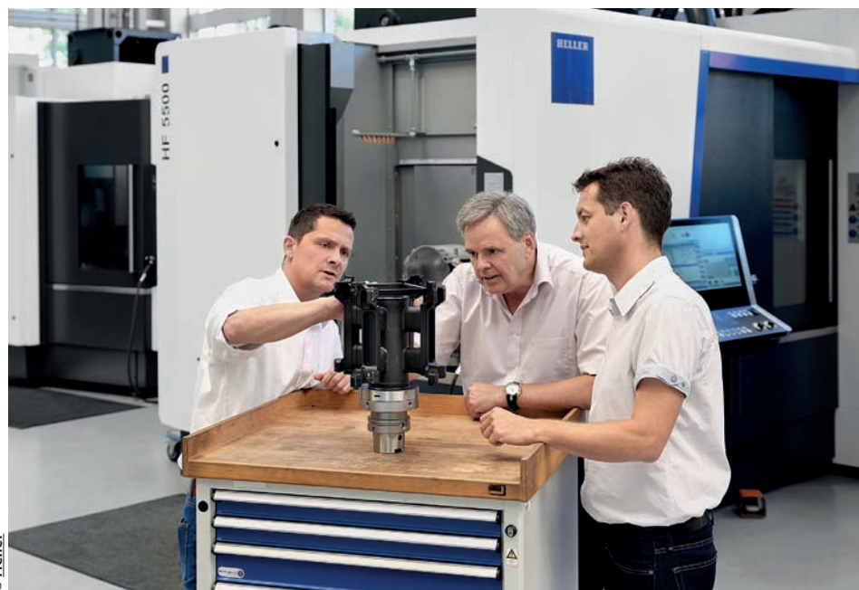
» Les caractéristiques impressionnantes de l'outil comprennent son faible poids et ses arêtes PCD finement réglables
