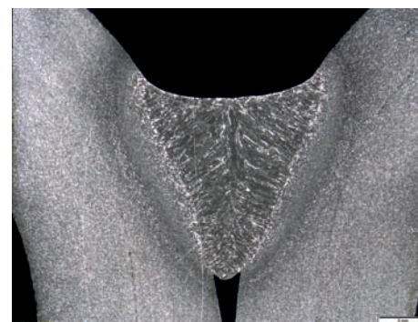
» La caractéristique PCS marque des points grâce à son arc électrique concentré assurant une pénétration profonde
