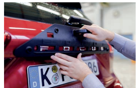
» Ford s'appuie sur le logiciel Paramate de Trinckle permettant à n'importe quel collaborateur de créer des gabarits de composants
