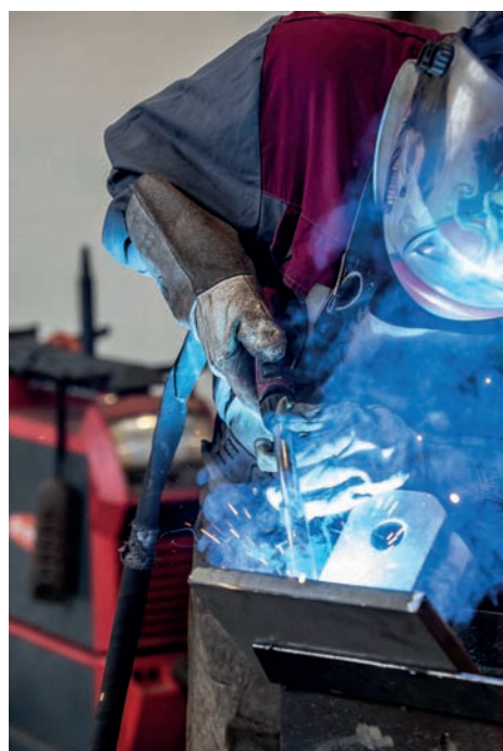
» La TPS/i Steel Edition dispose de différentes caractéristiques spécifiques à l'acier pour les arcs pulsés comme pour les arcs standard
