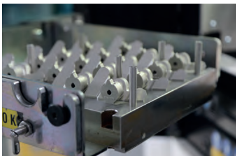
➤ Production en série par fabrication additive de moyeux endoscopiques pour turboréacteurs à réducteur d'Airbus A320neo. (Source : MTU Aero Engines)
