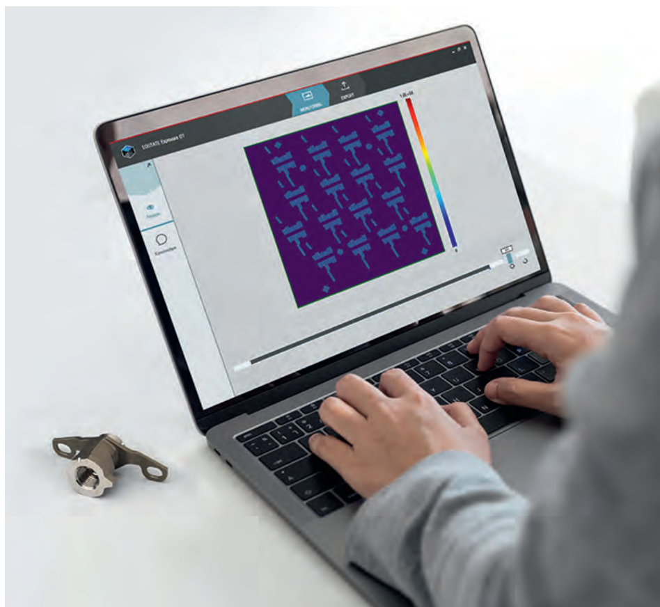
➤ MTU Aero Engines s'appuie sur la surveillance en direct couche par couche du processus de fabrication à l'aide d'EOSTATE ExposureOT pour tester les composants produits en FA (source : MTU Aero Engines)
