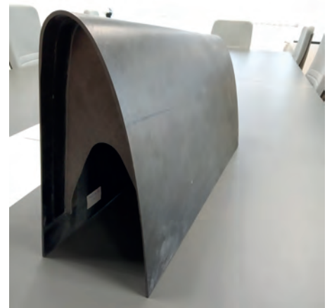
La pièce composite finale d'une aile d'avion courbe, produite avec la technologie FDM de Stratasys
