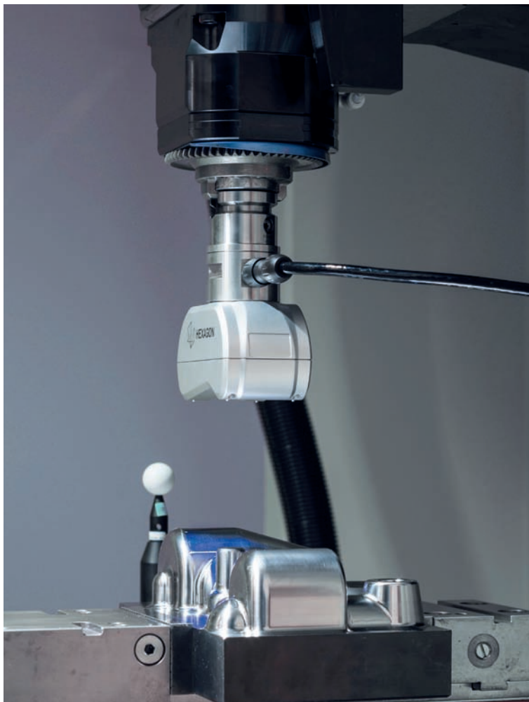
➤ Avec son système breveté de mesure par ultrasons dans la machine-outil, Hexagon ouvre de nouvelles voies dans la mesure automatique des épaisseurs de paroi
