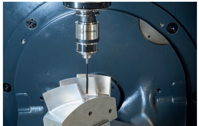
➤ Avec le RWP20.50-G-UTP, un palpeur à ultrasons est disponible pour la première fois en tant que standard industriel pour la mesure dans la machine-outil
