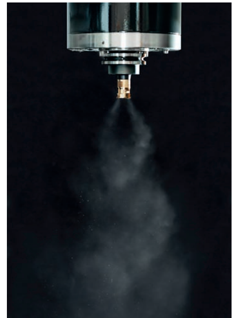
➤ Spectre d'arrosage en micro-lubrification
