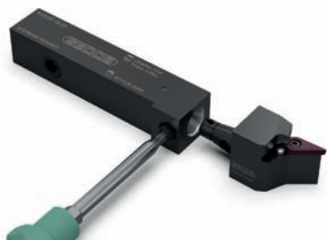
» Jetstream Tooling Duo ajoute un second canal de lubrification sur la dépouille de la plaquette
