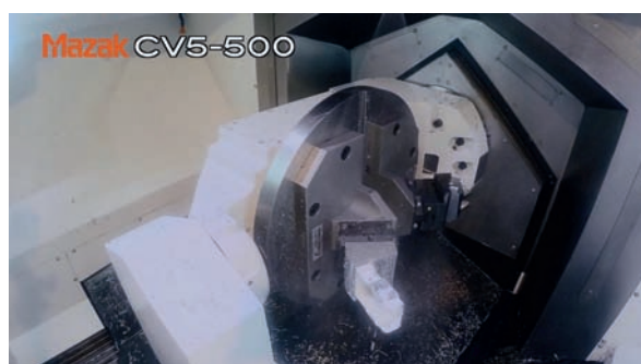
» La machine est équipée d'une nouvelle broche polyvalente de 12 000 tr/min
