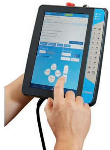
Nouveau boîtier de programmation Smart Pendant de Yaskawa pour les environnements robotiques « Industrie 4.0 » (Source : Yaskawa)
