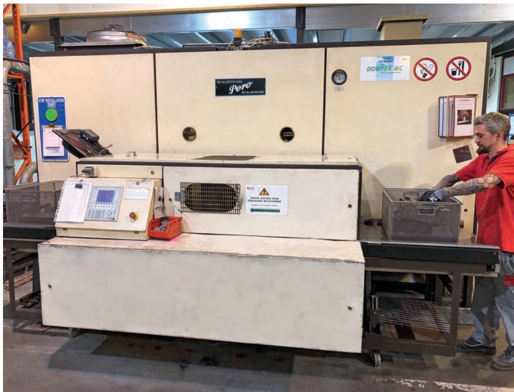
» Sur le site de Besançon, l'installation Pero adopte un chargement automatisé des paniers positionnés sur un tapis de convoyage
