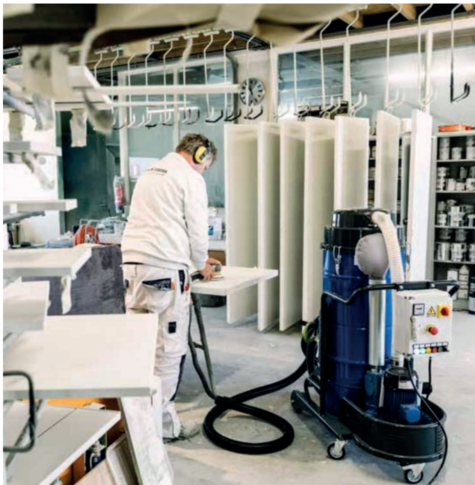
► Équipement d'aspiration des poussières en action dans l'atelier
