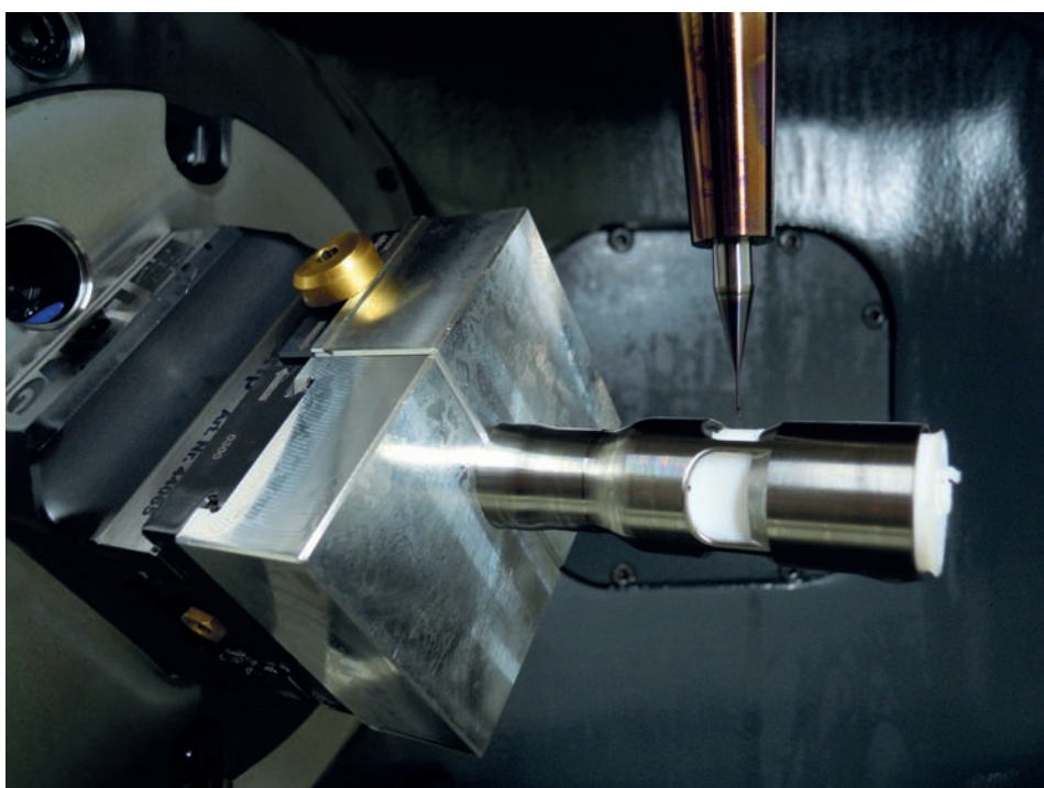
➤ La VQ présente une excellente tenue dans le temps – plus de 300 heures d'usinage – et une impressionnante répétabilité de la fraise
