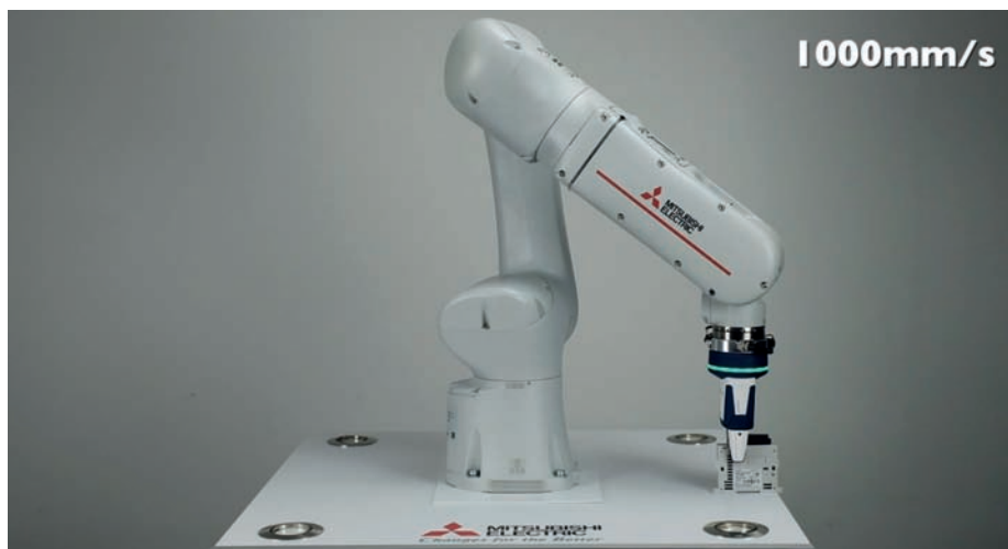
► Le cobot Melfa Assista offre un mode de fonctionnement à grande vitesse lorsqu'il ne travaille pas à proximité des opérateurs et peut donc être aussi utilisé comme un robot industriel standard - [Photo : Mitsubishi Electric Europe B.V.]
