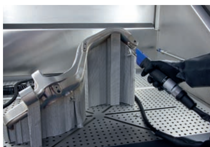
► Retrait efficace des structures de support à l'aide d'un burin
