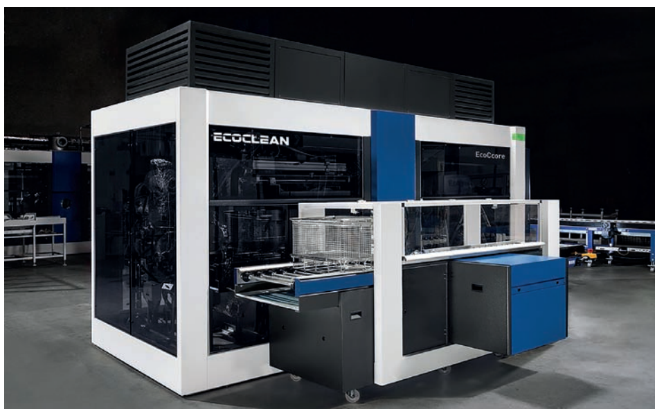
» L'EcoCore, développé pour les procédés de nettoyage aux solvants, allie flexibilité maximale et grande performance, avec une rentabilité optimale et un fonctionnement simple
