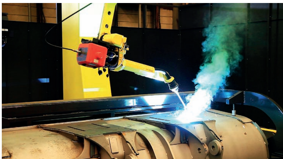
Le TPS 600i associé au Welding Package PMC utilisé au niveau de la pelle mécanique
