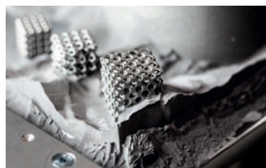
► Pièce produite grâce au procédé de fusion sélective par laser (SLM)
