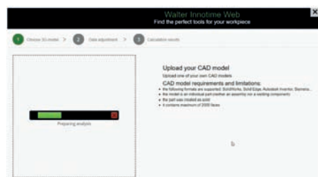
➤ Étape 1 : le modèle 3D du composant peut simplement être glissé déposé dans l'application - Image : Walter AG
