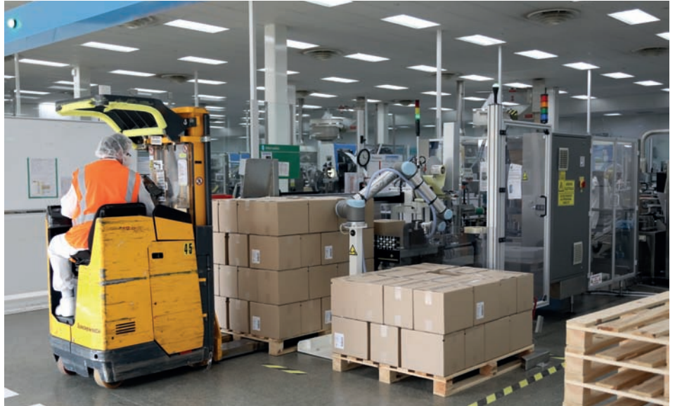
» Cobot UR10 installé sur des fins de lignes très serrées grâce à sa compacité
