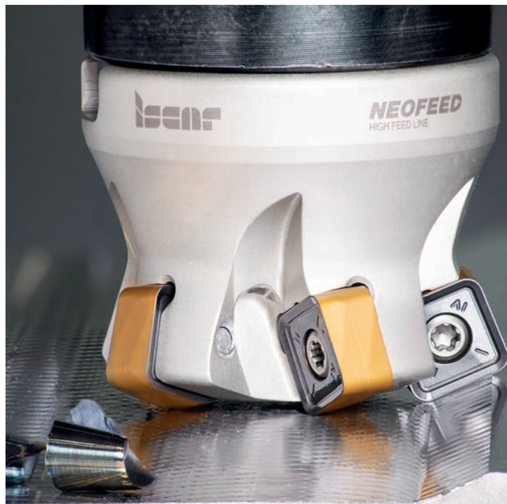
» Fraise haute avance NEOFEE avec plaquettes économiques à 8 arêtes de coupe
