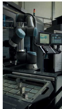
» Bras ProCobot d'Universal Robots, partenaire robotique d'Hurco, avec en arrière-plan le directeur de commande d'Hurco à partir duquel il est possible de programmer les opérations d'usinage et de les transférer au robot
