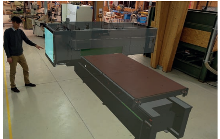
» Parmi les applications de HoloLens2 figure le positionnement de l'outil avant l'usinage de la pièce
