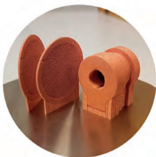
► Pièce obtenue à partir de la technologie SLM (Selective Laser Melting) équipée d'un laser « vert »
