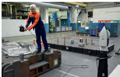
► Le Leica Absolute Tracker AT960 peut être directement amené dans l'atelier de fabrication pour scanner des pièces d'essai avec le Leica T-Scan 5
