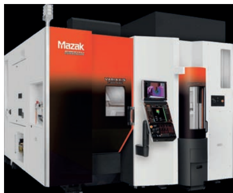
➤ Le Variaxis i-300 AWC est doté d'un système d'automatisation compact pour l'usinage d'une grande variété de composants.
