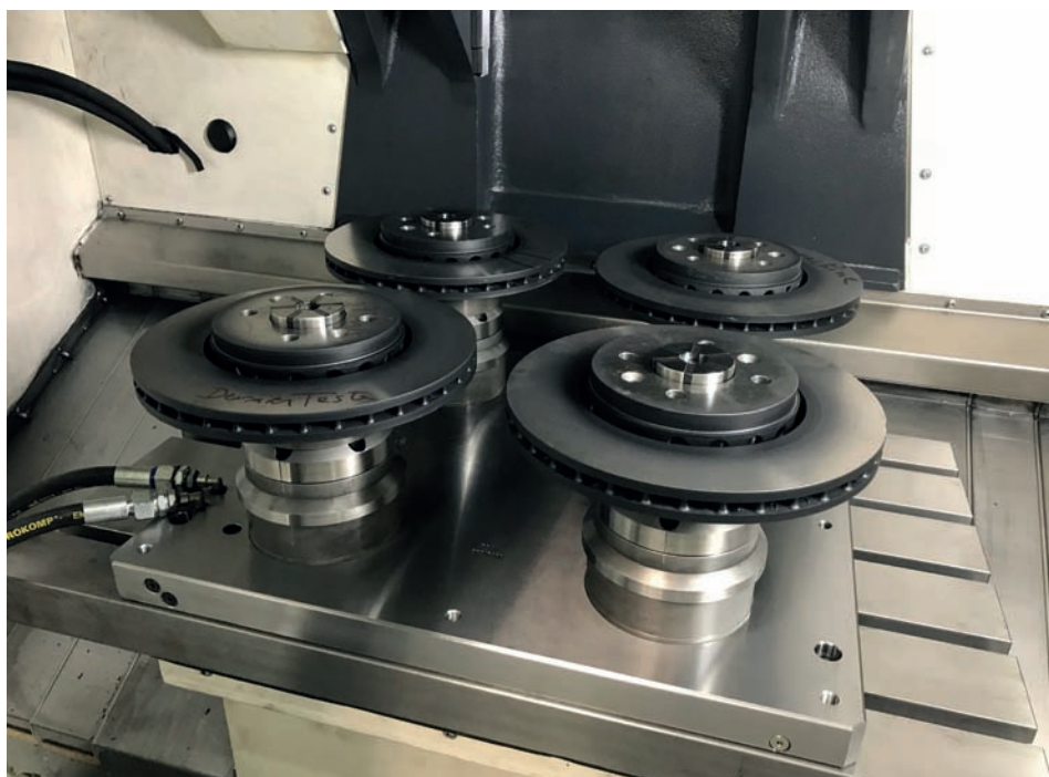
➤ Montage d'usinage hydraulique - Opération de perçage de disques de frein ventilés
