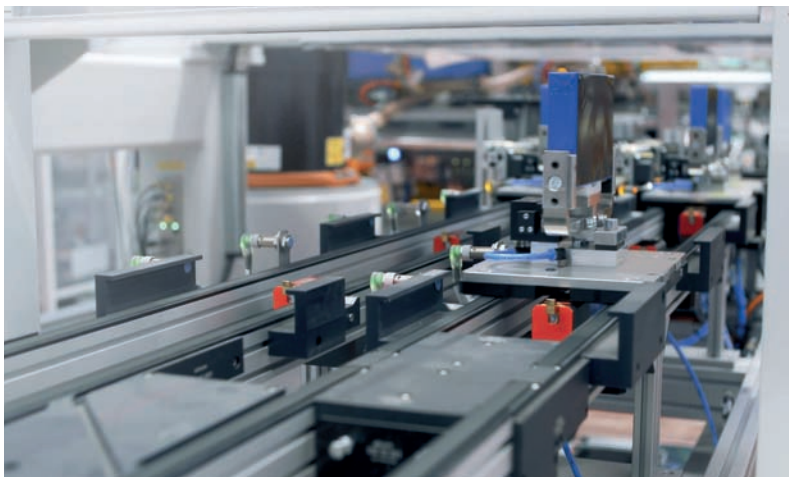
➤ Fabrication de modules de batteries
