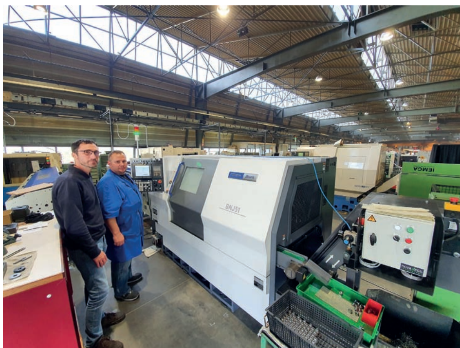
➤ L'atelier de l'entreprise MPM ne compte pas moins de dix tours à poupée mobile Citizen-Cincom et trois tours à poupée fixe Citizen-Miyano
