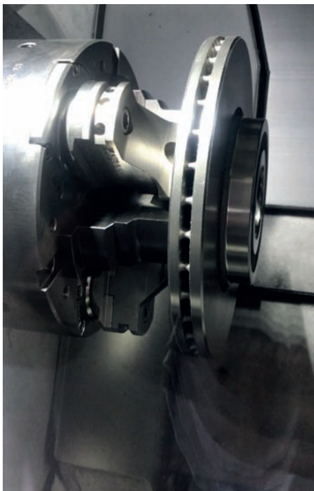
➤ Opération de tournage sur disque de frein
