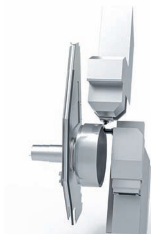
» Usinage complet en 4 axes de bagues
