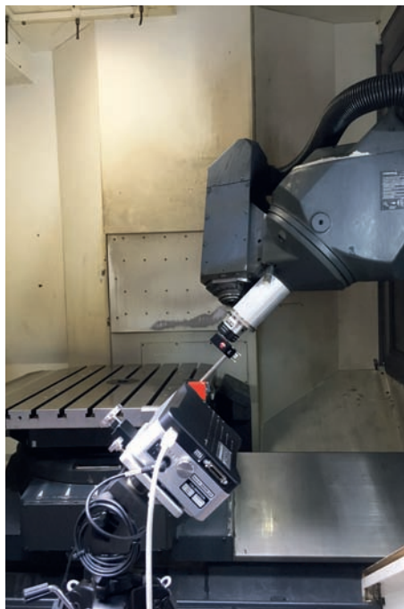
➤ Axe rotatif sur centre d'usinage DMC de DMG Mori 100P axe B à 45°
