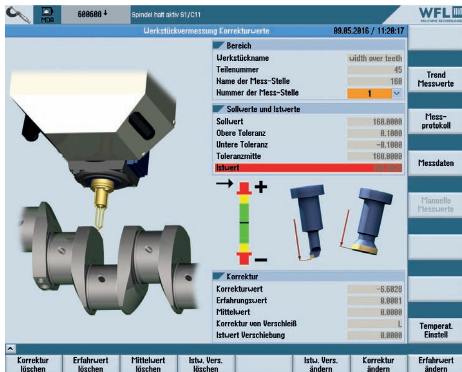
Figure : Les mesures sont affichées (valeur réelle, valeur nominale, tolérance, etc.) sur l'écran de l'unité de contrôle
