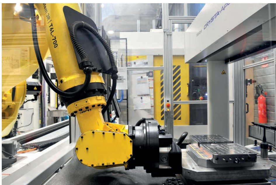
Le robot 6 axes fait partie intégrante d'une ligne entièrement automatisée de moules
