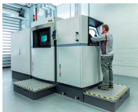
➤ Audi utilise l'imprimante 3D industrielle EOS M 400 pour produire des segments d'outils (source : AUDI AG).
