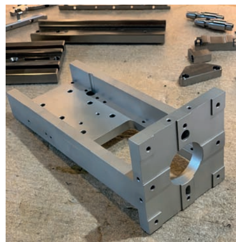
➤ Pièce à l'usinage très précis destinée à la machine spéciale
