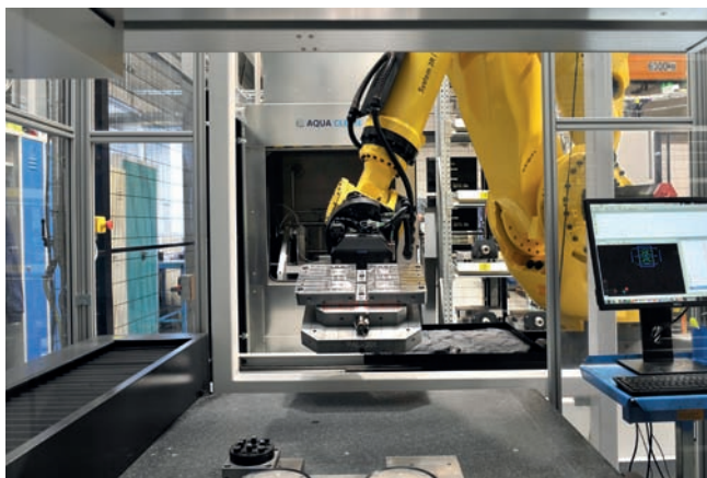
Délicatement, le robot 6 axes Fanuc T-6-L 700 dépose les pièces dans la MMT Crysta-Apex de Mitutoyo
