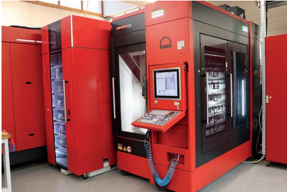
► Depuis 2020, l'atelier Innerbichler exploite la Kern Micro HD 24 heures sur 24 et deux équipes travaillent sans opérateur
