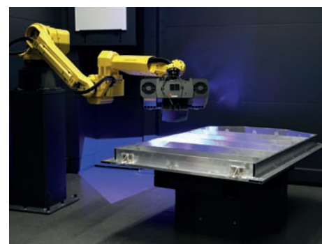
► Cellule de mesure de composant dans le centre de prototypage Fronius
