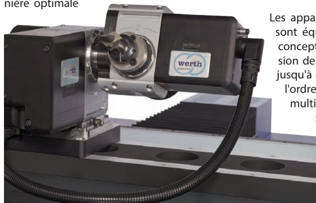
➤ Les axes de rotation et d'inclinaison permettent de résoudre des tâches de mesure complexes.
