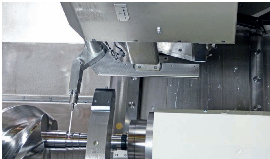
Figure : Mesure de la pièce avec le palpeur de mesure sur l'unité de tournage-alésage-fraisage.
