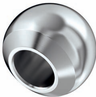
► L'alésage conique de la tête fémorale est obtenu avec une extrême précision dimensionnelle et surfacique, sur un tour CN, grâce à un alésoir conique spécial
