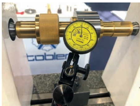
➤ Application d'un mandrin expansible TBAS sur un petit banc de serrage
