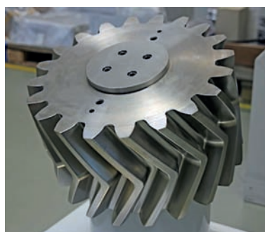
» Ce pignon droit en 16MnCr5, doté d'une denture à chevrons (Ø450 mm), a été fraisé en 18 heures et 45 minutes sur une Röders RXU 1001 DSH (Photo : Klaus Vollrath)
