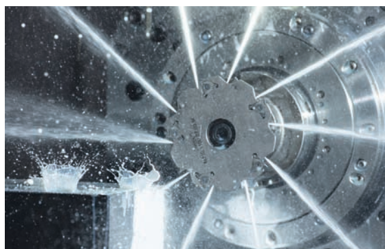
➤ L'alimentation interne en fluide de coupe améliore considérablement les performances des outils du système de fraisage M310
