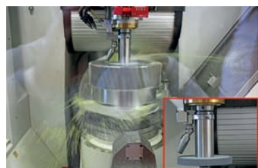
» La roue de meulage pour la rectification cylindrique intérieure ou extérieure dispose de sa propre alimentation d'huile intégrée qui est changée avec l'outil (Photo : Klaus Vollrath)
