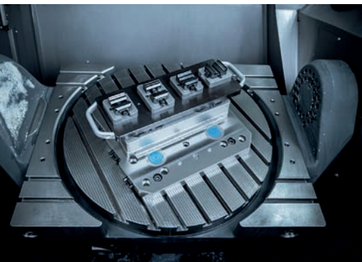
➤ Ses mâchoires à changement rapide permettent de réduire les temps morts et son corps en acier inoxydable garantit, pour l'utilisateur, une longue durée de vie
