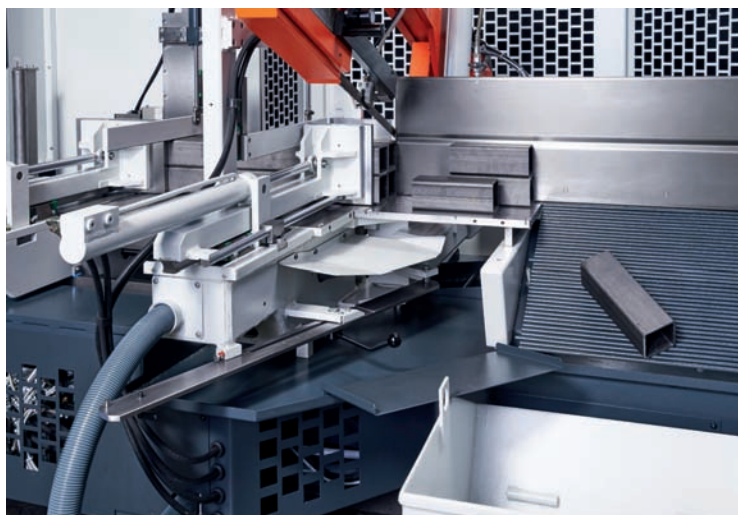
➤ L'évacuation des pièces coupées peut se faire de différentes manières : par simple inclinaison de la goulotte, elles tombent dans un conteneur
