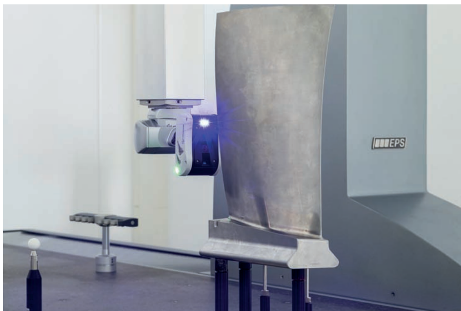
➤ Le HP-L-10.10 complète l'offre étendue d'Hexagon en matière de solutions de capteurs pour MMT
