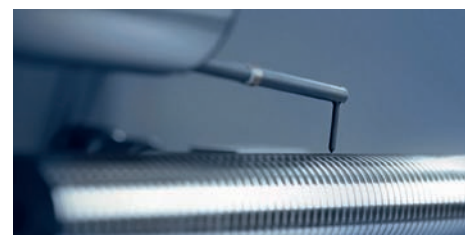
➤ Capteur tactile : Les méthodes de mesure tactiles sont toujours considérées comme les plus précises du marché
