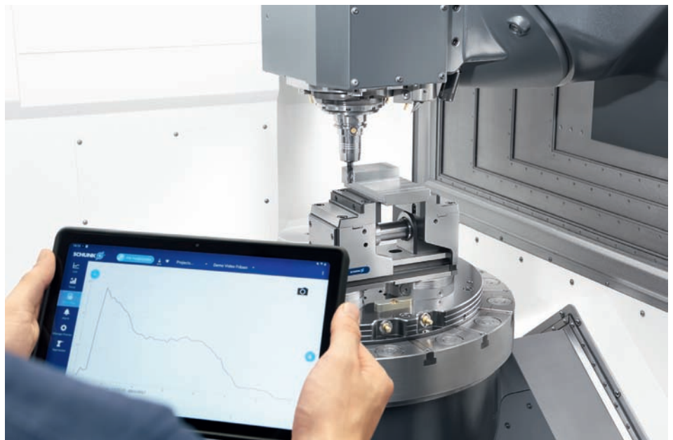
➤ Étape importante vers la numérisation dans le serrage d'outils : avec l'iTENDO 2 , les utilisateurs peuvent surveiller simplement leurs processus d'usinage
