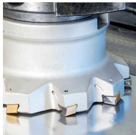
» La fraise à plaquettes indexables TANGFIN utilise le principe de déplacement graduel de la plaquette
