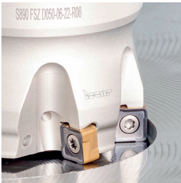
» Plaquettes NEODO réversibles carrées pour l'ébauche avec racleur intégré pour un meilleur état de surface
