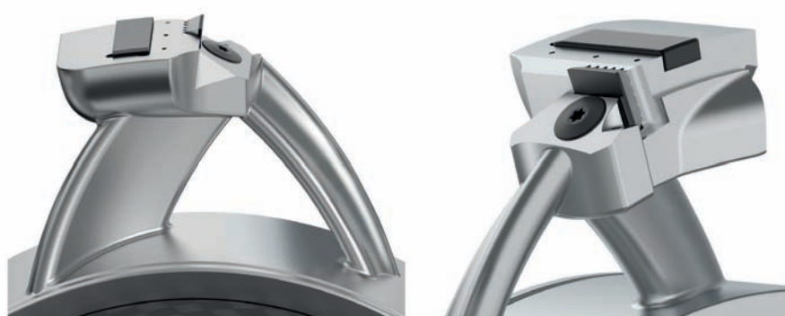
➤ Les bras en forme de profil d'aile avec arrosage interne et technologie d'alésage RIQ (des caractéristiques internes et externes complexes rendues possibles par la fabrication additive)
