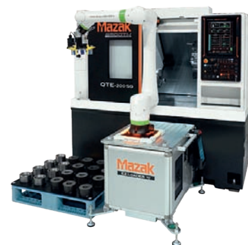
► Pendant l'EMO, cette cellule d'automatisation cobot Ez Loader a été intégrée sur un centre de tournage QTE-200 SG
