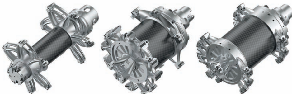
➤ À gauche, outil de première génération (9,5 kg) et, à droite, dernière version (moins de 8 kg) pour un changement d'outil sans souci
