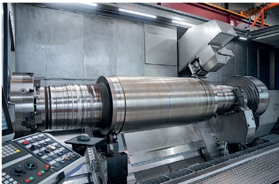
» Rouleau en acier trempé dans un Millturn M150, zone de travail fermée pour l'usinage avec des pressions d'arrosage élevées
