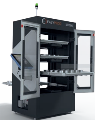
» Le magasin communique directement avec le robot, lequel charge et décharge les brutes et les usinées, offrant plus d'autonomie à la production des centres d'usinage et/ou des tours CN, le tout sur une même ligne
