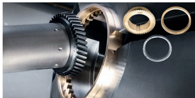
À gauche : exemples de différentes bagues d'embrayage utilisées, par exemple, dans les embrayages à dents ou les freins à dents ; à droite, gearSKIVING d'une bague d'embrayage en alliage de bronze spécial réalisé sur le CTX beta 800 TC
