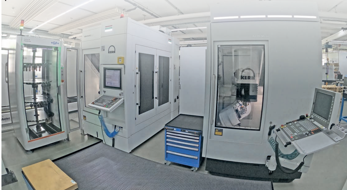
» Précision et productivité dans la fabrication d'outils chez Wild & Küpfer AG avec la Kern Micro HD entièrement automatisée (à gauche) et la Kern Micro (à droite)
