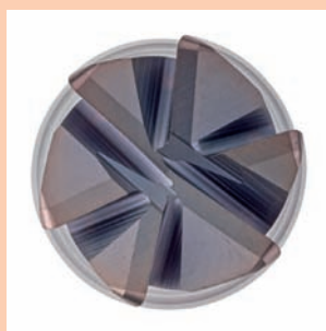
» Hélices variables : Les angles d'hélice varient jusqu'à 4° pour éviter les vibrations
