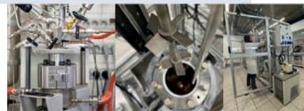
» Le réacteur permettant la polymérisation à 80 bar de pression
