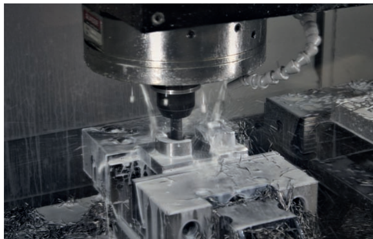
► Avec la fonction OCM, toute la longueur de l'outil est exploitée, pour un usinage plus efficace
