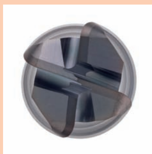
» Hélices variables : Les angles d'hélice varient jusqu'à 4° pour éviter les vibrations
