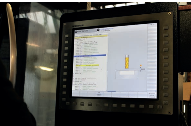
» Grâce à la programmation en langage conversationnel et aux représentations graphiques, le cycle d'ébauche OCM se paramètre de manière conviviale sur la TNC 640
