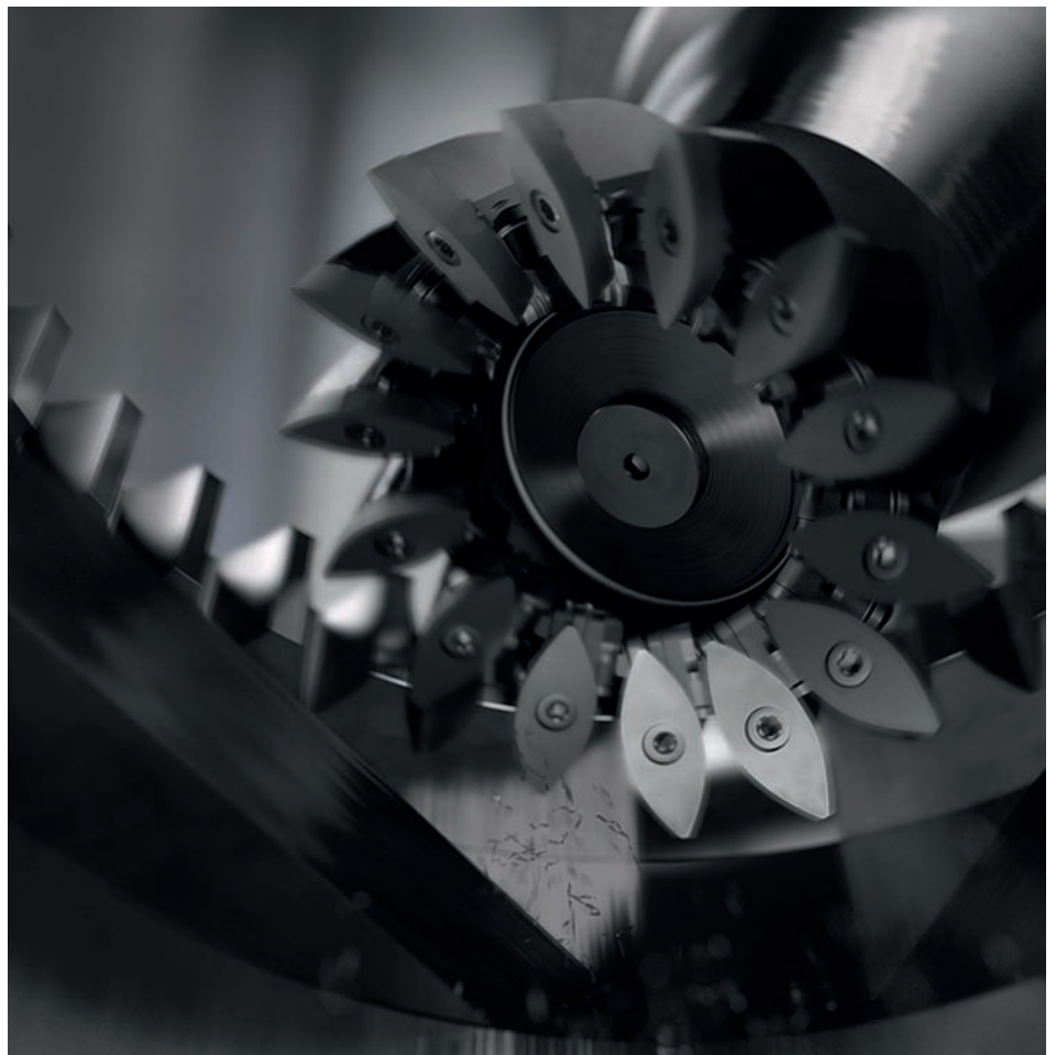
» La fraise à plaquettes indexables CoroMill 180 pour le Power Skiving permet d'usiner des dentures en un seul montage
