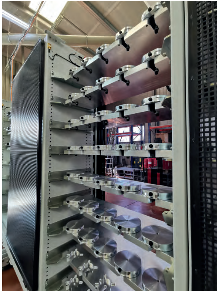
» Intérieur du magasin Erowa
