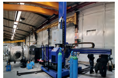
► Installation automatisée de soudage de type Potence ©Allia
