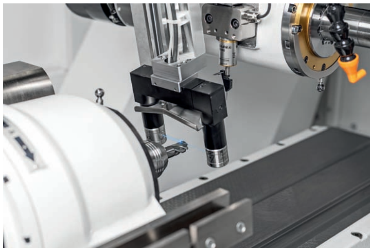
» Option Laser Contour Check de Walter avec faisceau laser bleu
