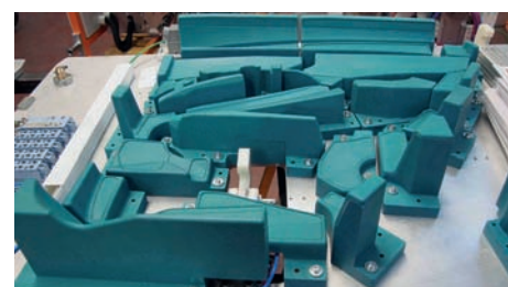
» Pièce d'insert en résine réalisées par Mastercam et destinées à recevoir un panneau de porte pour y effectuer de la soudure par ultrason
