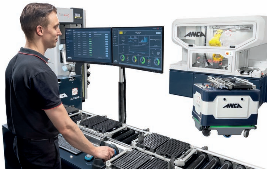
» La station de préparation du travail appelée « Autoset » comprend le serveur AIMS avec sa propre suite logicielle Anca pour les interfaces de données et le monitoring
