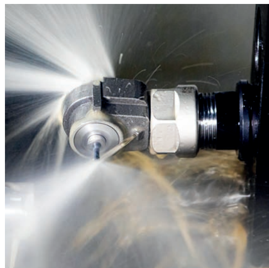
» Fig. 4 - Broche compacte haute vitesse générée par l'arrosage intégré
