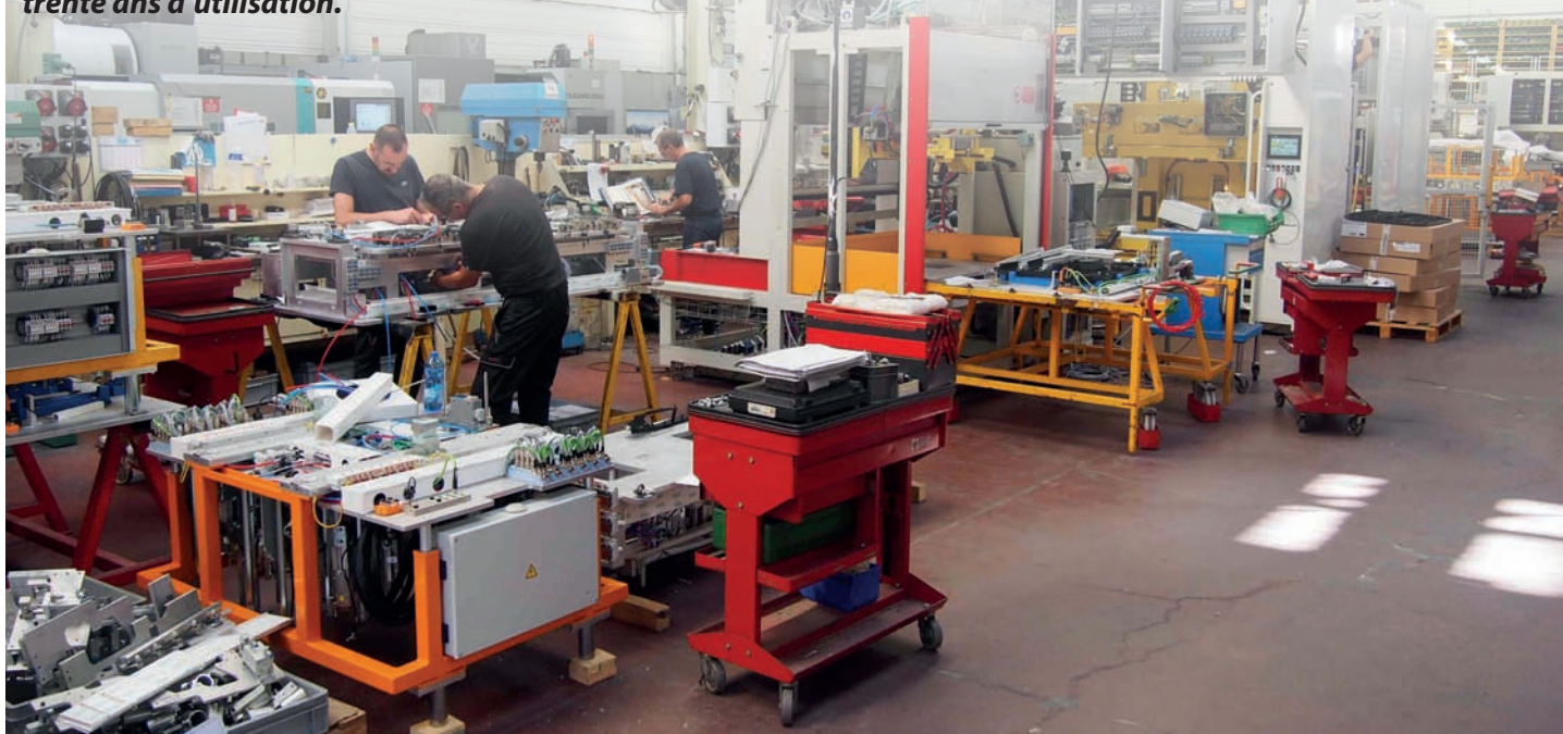
» Aperçu de l'atelier de montage de machines, pour une production d'une cinquantaine d'unités par an
