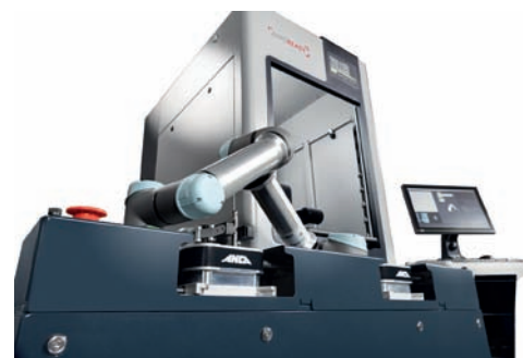
» Avec le partenaire de longue date Zoller, il a également été possible d'intégrer et d'automatiser la mesure et la compensation
