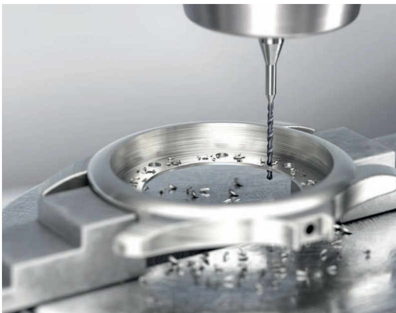
» Le CoroDrill 862 de Sandvik Coromant dans la géométrie GM peut être complété par une arête de coupe en PCD veiné
