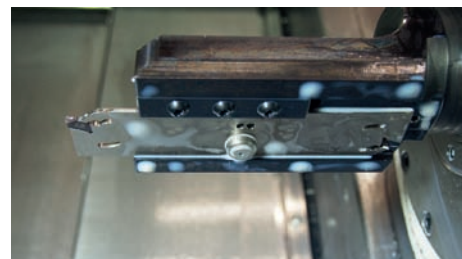
» Lame tronçonnage Diaedge GW avec arrosage interne
