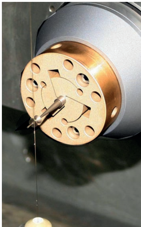
» Broche tournante et diviseur Hirschmann pour le micro-usinage sur machine à fil
