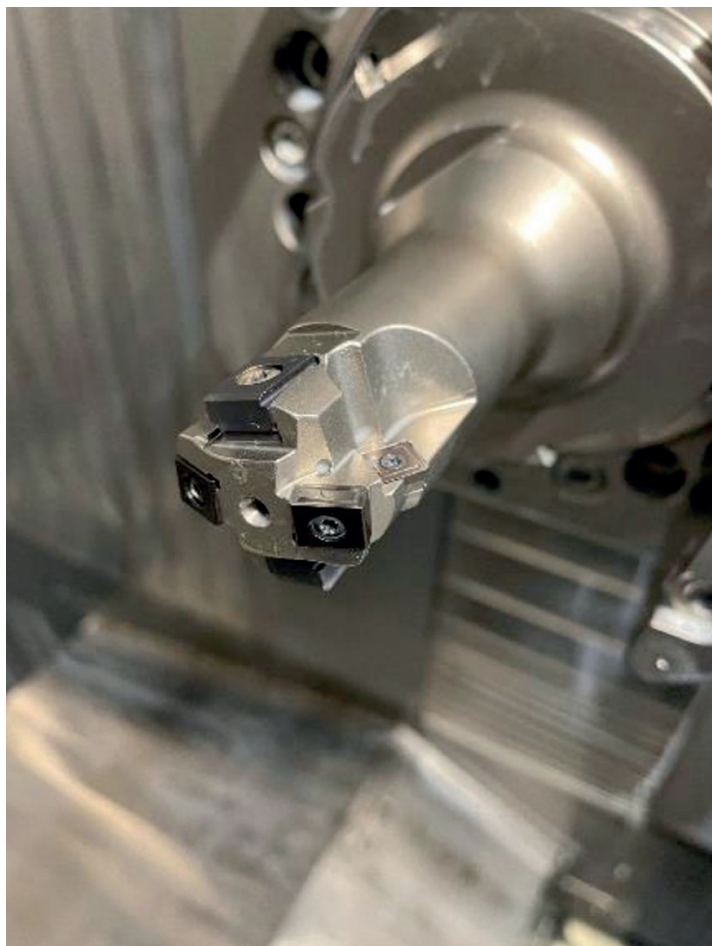
» Un seul outil pour l'ébauche, le chanfreinage et la finition : le nouvel outil d'usinage à bouchon d'eau de Ceratizit. Les forces de coupe sont faibles grâce à la géométrie positive des nouvelles plaquettes d'alésage R84. Cela permet de combiner l'ébauche et le chanfreinage dans un seul outil.
