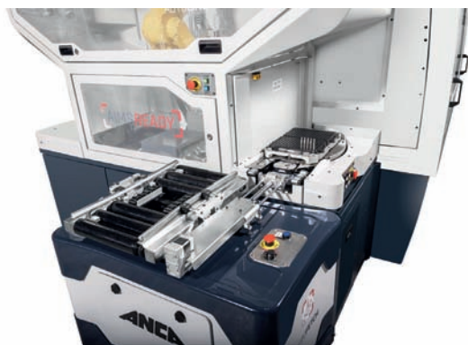
» Le transfert des outils ou des palettes d'outils du transporteur AMR vers la station de chargement intégrée s'appuie sur des interfaces et des concepts d'automatisation existants
