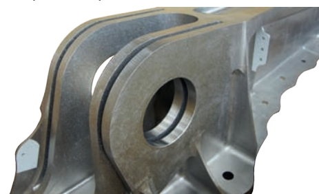
➤ Exemple de pièce de grande dimension - un « underwing », pièce reliant le dessous de l'aile.
