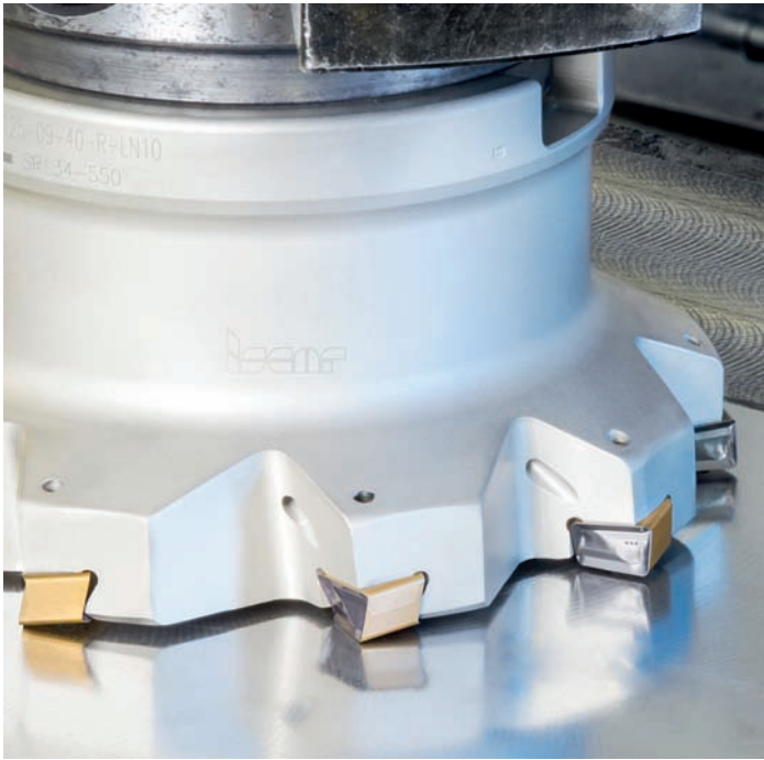
► Fig. 3 – La fraise à plaquettes indexables TANGFIN utilise le principe de déplacement graduel de la plaquette.
