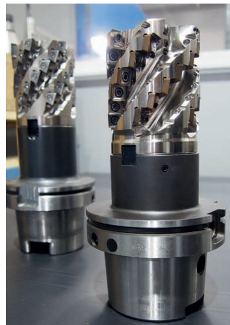
➤ Les deux fraises utilisées chez Figeac Aero : derrière, l'ancienne et devant, l'ASPX.
