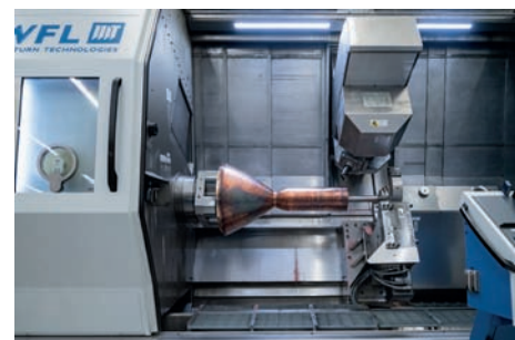
► La technologie Millturn permet de combiner une multitude de processus différents et d'effectuer facilement des tâches qui n'étaient possibles auparavant qu'avec des montages complexes et un serrage compliqué.
