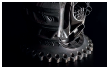
► Buse Aerospike : conception algorithmique générée par logiciel et validée par Hyperganic, fabriquée sur un système EOS M 400-4 (source : EOS).
