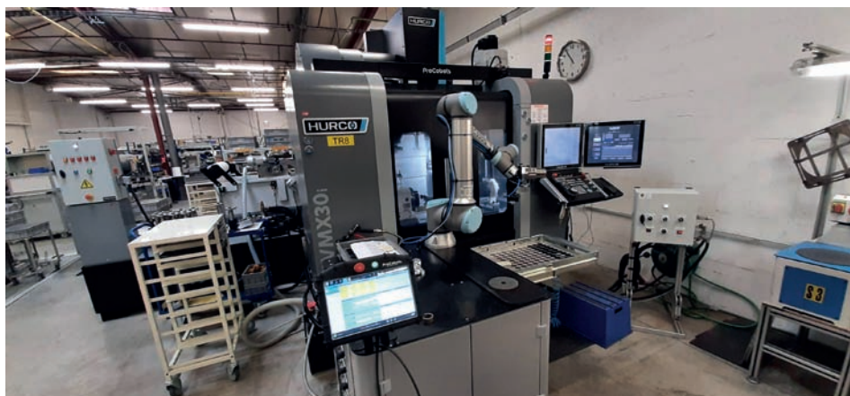
➤ Vue d'ensemble de la solution composée d'un centre 4 axes Hurco VMX30i et d'une cellule cobotisée ProCobots avec un bras Universal Robot
