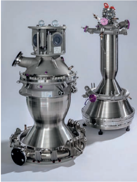
► Chambres de poussée des moteurs Ariane. Ici les deux premiers modèles de vol du moteur de l'étage principal Vulcain 2.1 et du moteur de l'étage supérieur Vinci.
