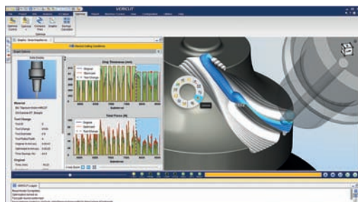
➤ Fonction d'optimisation avec VERICUT 9.3.
