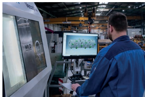
» Projet pilote : un écran installé sur le M120 Millturn afin d'offrir un accès aux designs, modèles 3D, temps d'usinage, etc.
