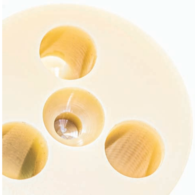
► Ce composant en « oxyde de zirconium renforcé d'oxyde d'aluminium » a été fabriqué sur une Kern Micro HD en un seul serrage grâce au fraisage et à la rectification par coordonnées avec un mode de coupe ductile.
