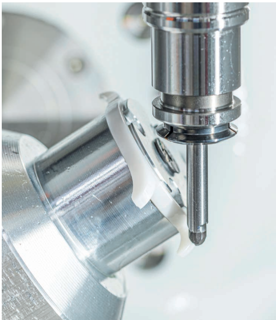
➤ Ici, un boîtier de montre en oxyde de zirconium est fraisé sur un Kern Micro HD en cinq axes avec des outils PCD complets. (Photos : Kern Microtechnik).
