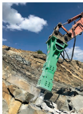
► Les brise-roches, comme les perforateurs, sont soumis à de fortes sollicitations mécaniques et nécessitent d'être fabriqués selon un haut niveau de qualité.
