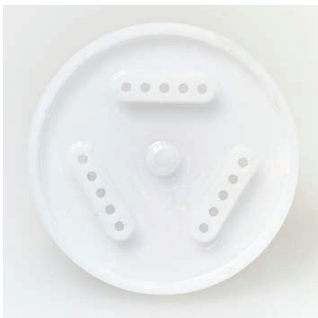
► L'échantillon de pièce en oxyde de zirconium présenté a été entièrement produit par perçage et fraisage avec des outils PCD complets et un mode de coupe ductile.
