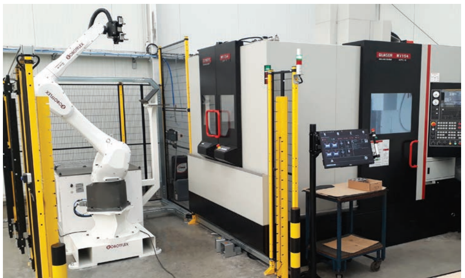
Centre 3 axes alimenté par une Robotflex CU 25 pour pièces de 10 kg avec poste de retournement. Machine équipée de deux étaux automatiques pour Opé1 et Opé2
