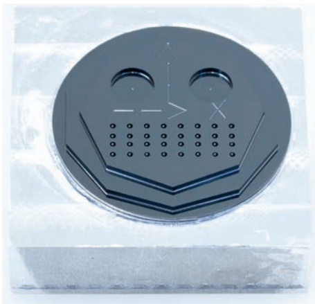
► Le fraisage de la céramique avec le mode de coupe ductile développé par Kern est d'autant plus productif que les usinages à réaliser sont petits.
