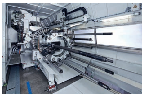
» Le changement automatique d'outil avec des outils longs s'effectue à l'aide d'un magasin pick-up et d'un changeur d'outil prismatique
