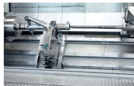
» Le perçage de trous profonds est particulièrement difficile avec des matériaux comme l'inconel, exigeant que le fabricant de la machine possède une expertise complète
