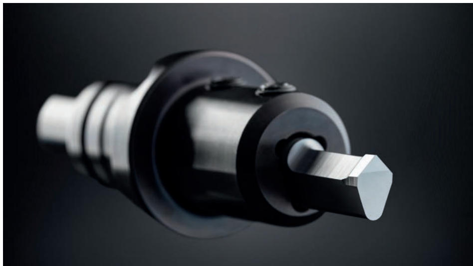
» Six pans par vis de mortaisage
