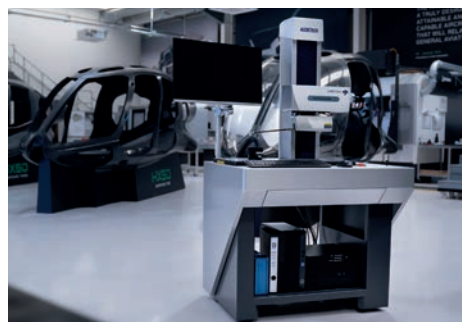
► Hill Helicopters a fait l'acquisition d'un Surfcom NEX 240 DX-13 auprès de Accretech UK afin d'inspecter avec une haute précision des surfaces et des profils de ses pièces fabriquées en interne
