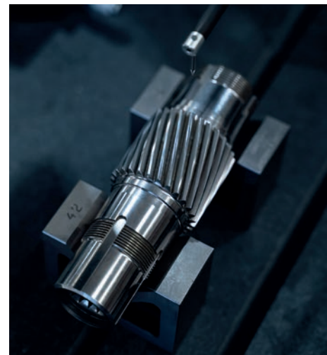
► L'utilisation d'un détecteur hybride permet de mesurer simultanément l'état de surface et le profil.
