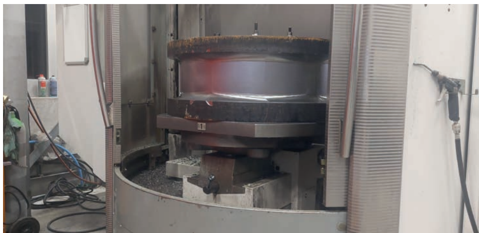
➤ Une paire de coussinets pour le moteur du bateau est en cours de fabrication, ce que la fraise à grande avance DiPosFeed d'Ingersoll a permis de réaliser avec un processus sûr. La pièce à usiner a un diamètre de 800 mm et une hauteur de 400 mm
