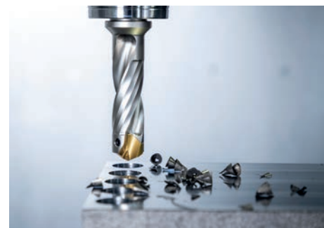
➤ Ceratizit propose les avantages d'un foret carbure monobloc et la flexibilité d'un système modulaire pour des processus de préparation rapides et une utilisation de matériau de coupe la plus faible possible.
