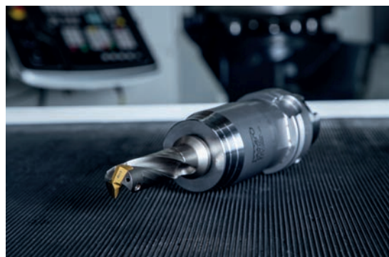
➤ Au lieu de remplacer l'outil complet, uniquement la lame interchangeable peut être mise au recyclage grâce au foret WPC – Change.
