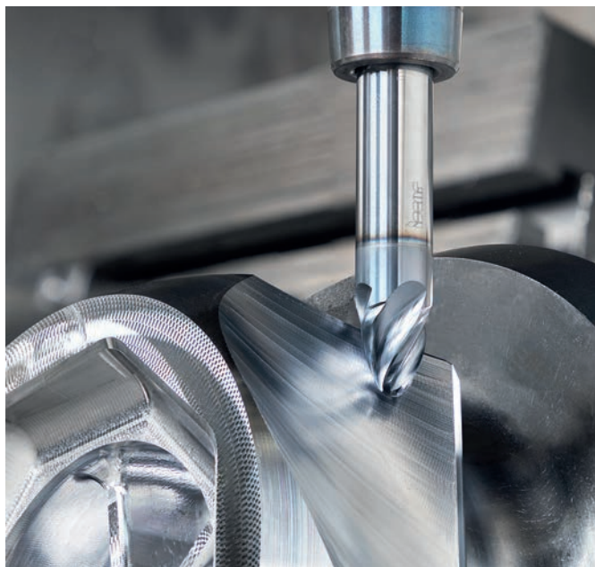
► Figure 1 : fraises ovales en carbure monobloc performantes pour l'usinage de formes courbes.
