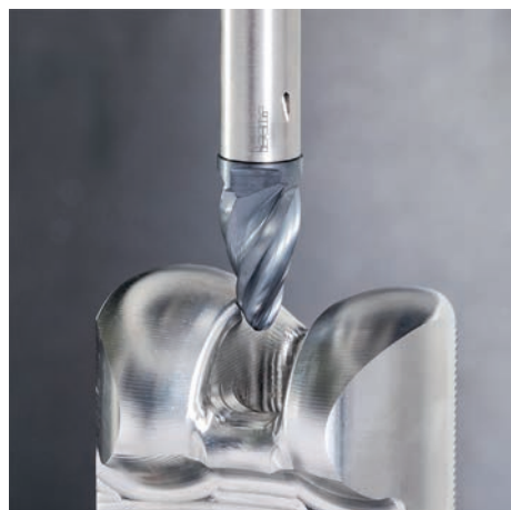
► Figure 2 : conception économique Multi-Master reposant sur un embout circulaire segmenté.
