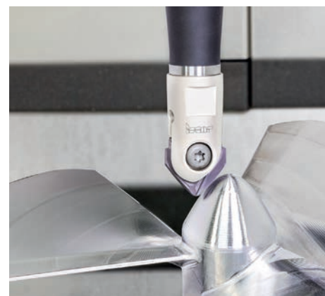
► Figure 3 : fraises tonneaux à plaquette unique : des performances élevées dans l'usinage de surfaces complexes de composants vitaux.
