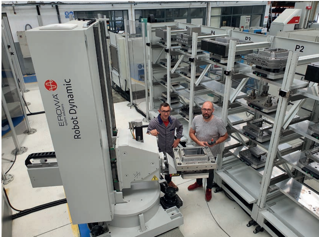
➤ Sous la pince du robot Erowa, le système de commande pneumatique de bridage des palettes
