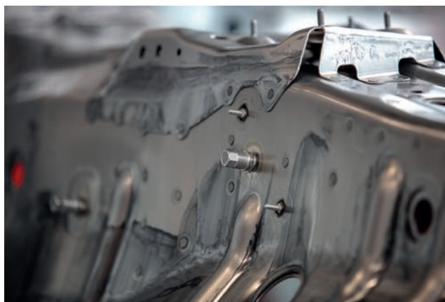
➤ Goujon de masse soudé du composant du tunnel de l'Audi A8.
