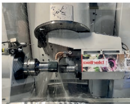
➤ Processus de rectification et de dressage avec SintoGrind TC-X 630.
