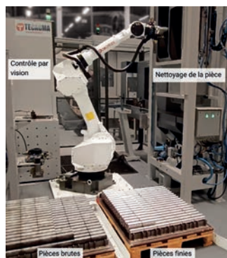
➤ Ilot robotisé RobotFlex par Tecauma intégrant le soufflage, le nettoyage et le contrôle de pièces.
