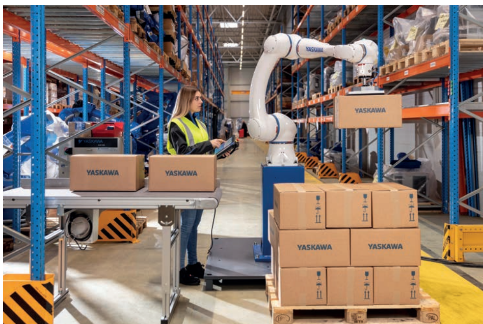
➤ Robot collaboratif Motoman HC30PL en cours de programmation dans une application de palettisation.
