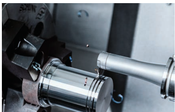
➤ Grâce à la lubrification interne du MaxiChange GX, les copeaux présents dans la rainure sont évacués de manière fiable par le débit élevé, l'usure de l'outil s'en retrouve réduite.
