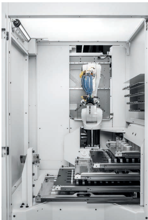
Centre d'usinage C12 de la série High Performance Line équipé du système robotisé RS05-2.
