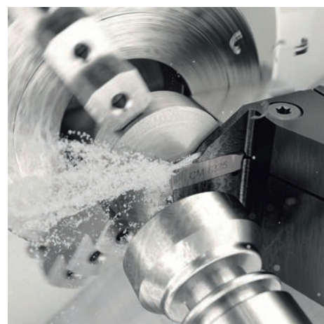
➤ Les lames de séparation de CoroCut 2 sont dotées d'un arrosage par l'intérieur.
