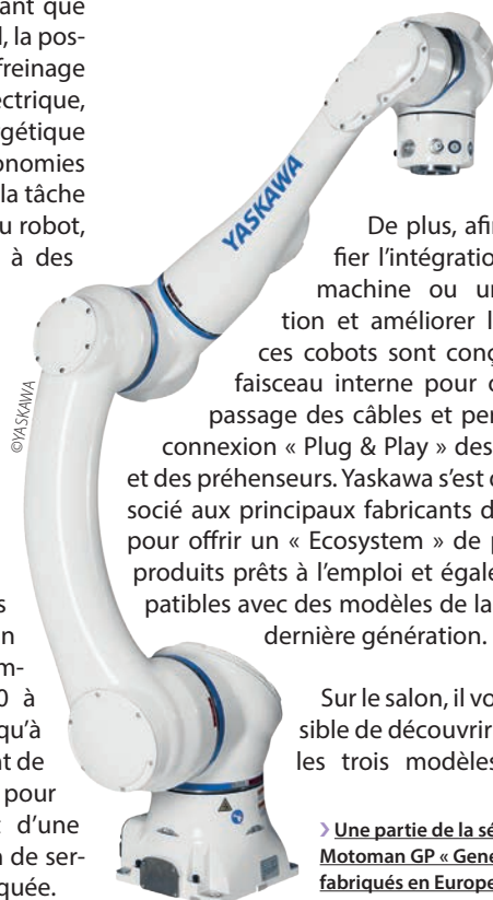
➤ Robot collaboratif Motoman HC30PL en cours de programmation dans une application de palettisation.
