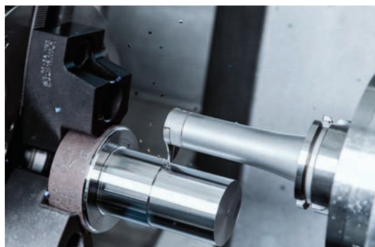
➤ Grâce à la lubrification interne du MaxiChange GX, les copeaux présents dans la rainure sont évacués de manière fiable par le débit élevé, l'usure de l'outil s'en retrouve réduite.
