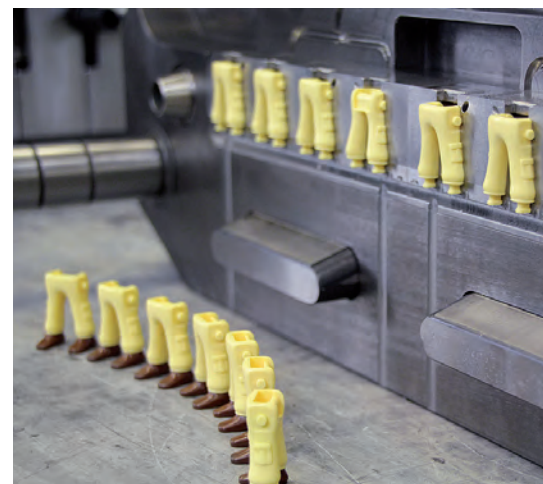
► Précision maximale pour la fabrication à injection des jambes à deux couleurs : aucun interstice ne doit apparaître après le refroidissement du plastique.
