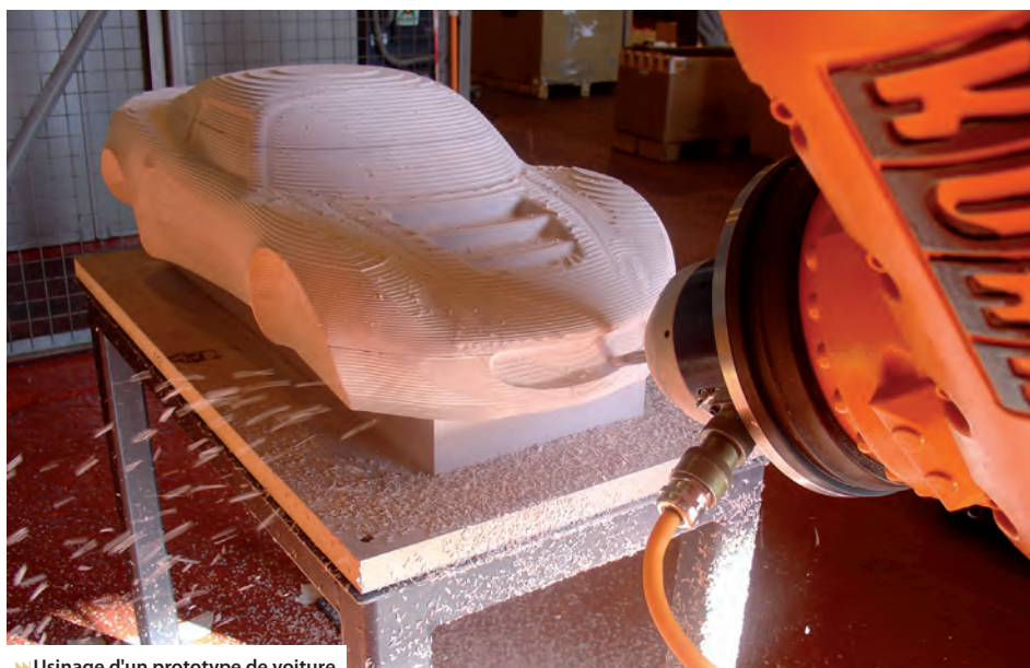
» Usinage d'un prototype de voiture
