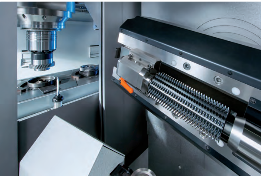
► EMAG KOEPFER - La machine VLC 200 H a été conçue pour des pièces en forme de bague avec un diamètre maxi 200 mm et module 4.
