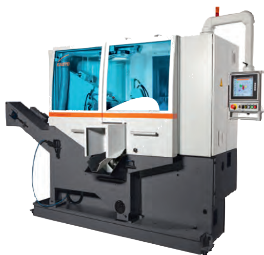
» Scie automatique à lame circulaire de production KASTOgripspeed C 10 avec son équipement standard, prête à fonctionner.
