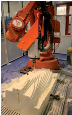
Exemple d'usinage par robot.
