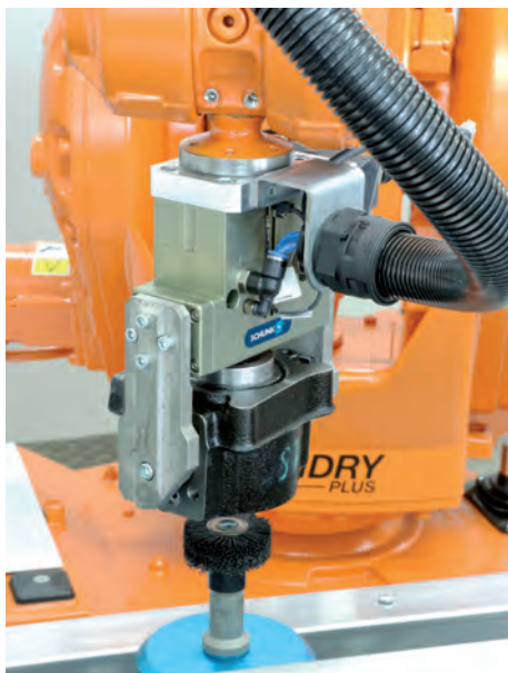
► Les pinces étanches DPG-plus de SCHUNK résistent aux volumes importants de poussière causés par les opérations de broissage.
