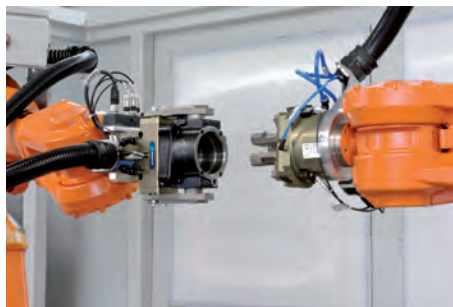
► Transferts de pièces automatisés : après l'ébavurage du premier côté, la pompe d'injection est transférée automatiquement au second robot.
