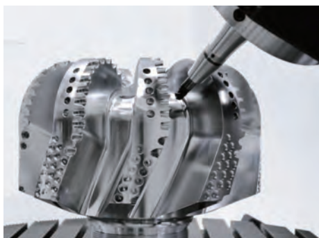
» Usinage complet d'une tête de perçage en un seul serrage avec 75 % d'économie de temps
