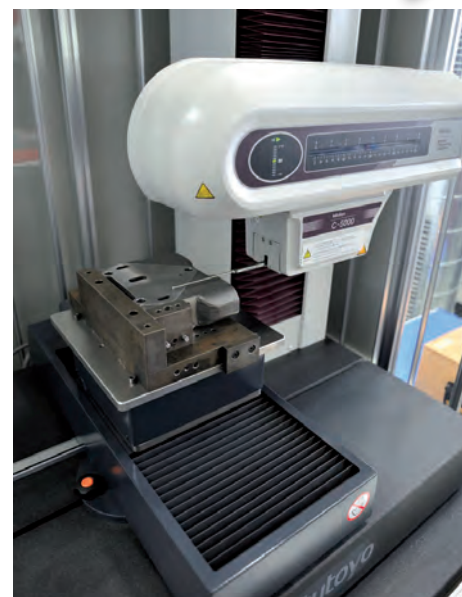
» DSC1045 : Le FormTracer CS 5000 contrôle l'état de surface et le profil d'une pièce en une seule séquence de mesure
