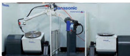
» Positionneur Panasonic intégrant les transmissions mécaniques Séries RD-C de Nabtesco
