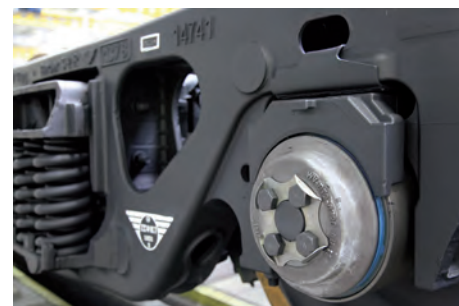
► Bogie Barber S-2-R du wagon avec une charge de 25 tonnes par essieu
