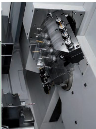
▲ Sur le M16 type VIII, les outils rotatifs sur le porte-outil vertical comportent un axe B en standard
