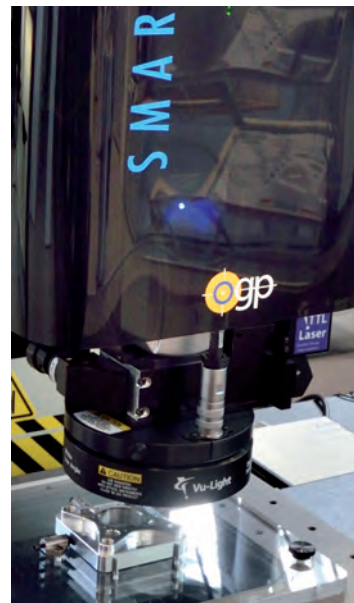
» L'extrême compacité du système multi-capteurs du ZIP Advance permet des affsets très faibles entre les capteurs
