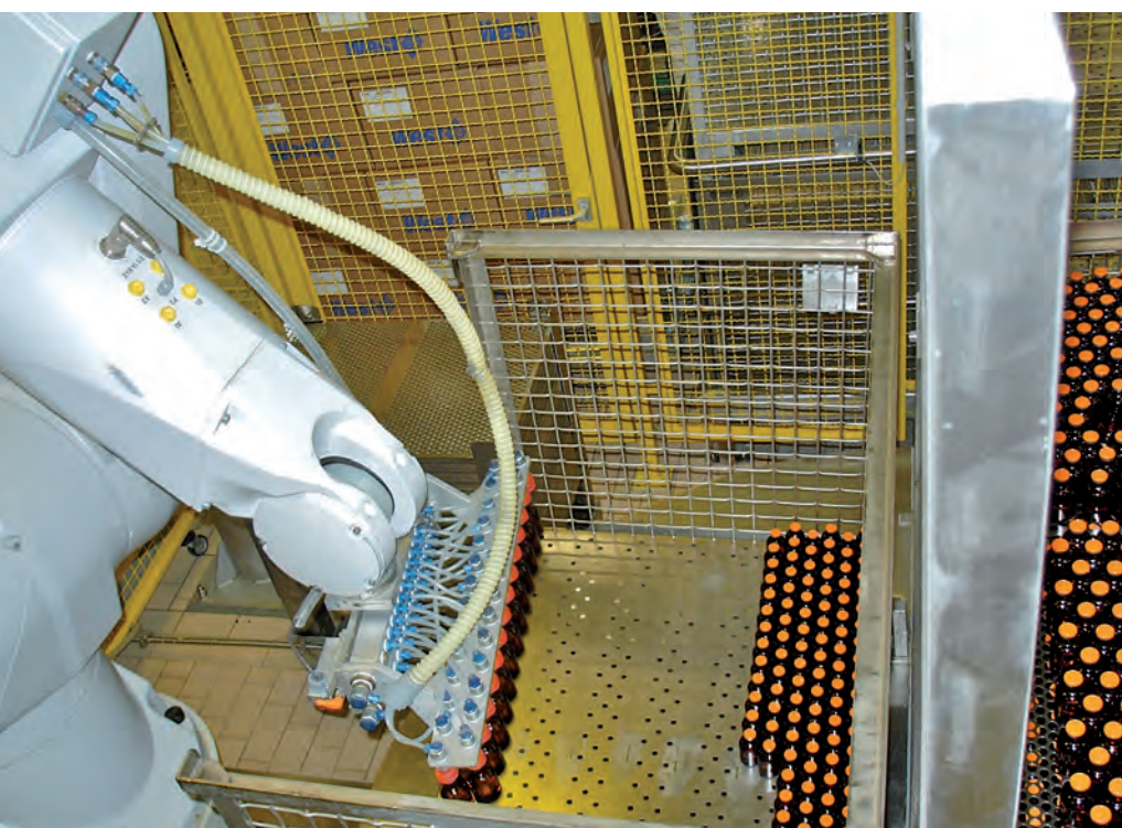
» Depuis dix ans, les robots Stäubli chargent des bouteilles dans des caisses en treillis métallique avec une très grande fiabilité
