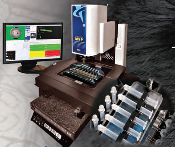
Contrôle de Seringues sur SmartScope MVP
