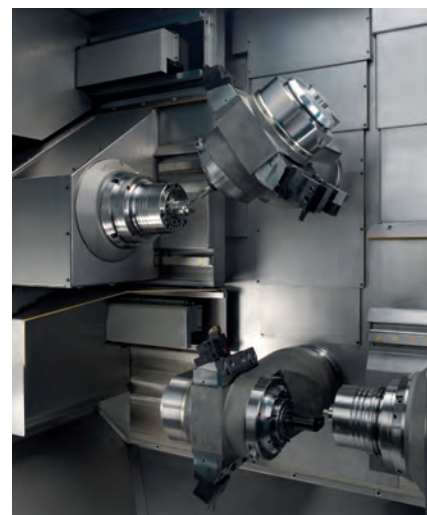
» Usinage de reprise complet : usinage performant (broche supérieure) et finitions précises (broche inférieure)
