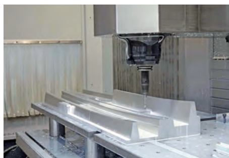
» Réalisation d'une empreinte de moule avec 1 débit matière de 500 cm 3 /mn en phase d'ébauche
