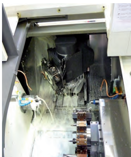
» L'arrosage des machines de décolletage est assuré par une centrale de 3000 litres de Blasocut BC 25 MD
